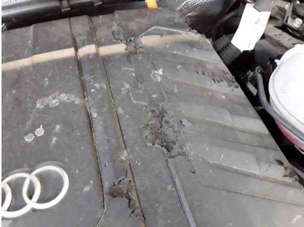
Beschädigung #4: Motor: Motorabdeckung - Marderschaden - erneuern
