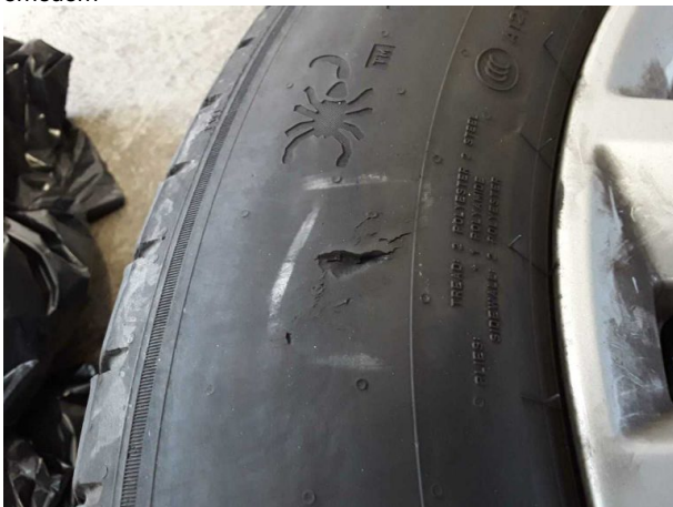
Beschädigung #5: 2.Radsatz: 1 Reifen - beschädigt - erneuern
