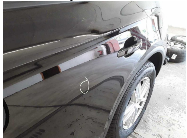
Beschädigung #3: Tür hinten links: Tür - Delle(n) - sanft instandsetzen
