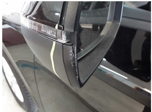
Beschädigung #6: Außenspiegel links: Spiegelgehäuse - verkratzt / verschürft - erneuern
