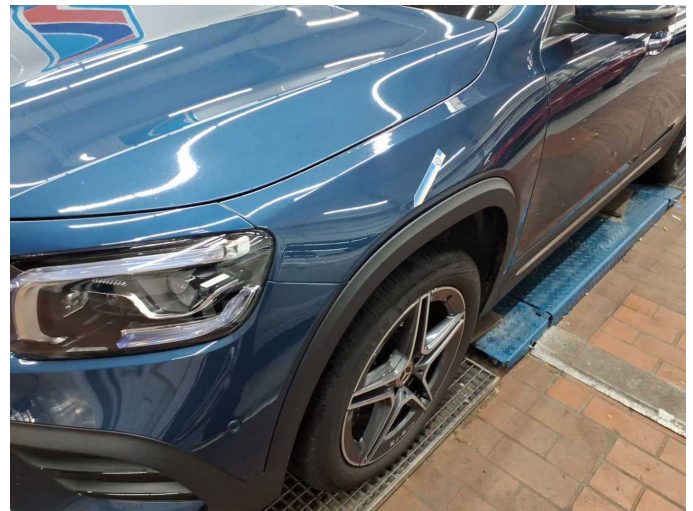
Damage 1: Mudguard - left side: Wheel well extension (3 mm Spalt zwischen Kotflügel und Radlauf) - Loose - Diagnosed and repair if necessary
