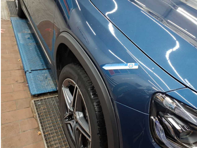
Damage 2: Mudguard - right side: Wheel well extension (4 mm Spalt zwischen Kotflügel und Radlauf) - Loose - Diagnosed and repair if necessary
