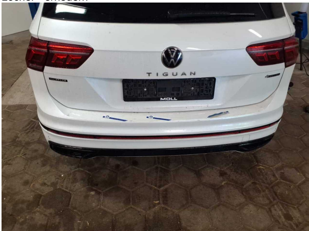
Beschädigung #2: Koffer: Ladekante - verkratzt / verschürft - Smart Repair
