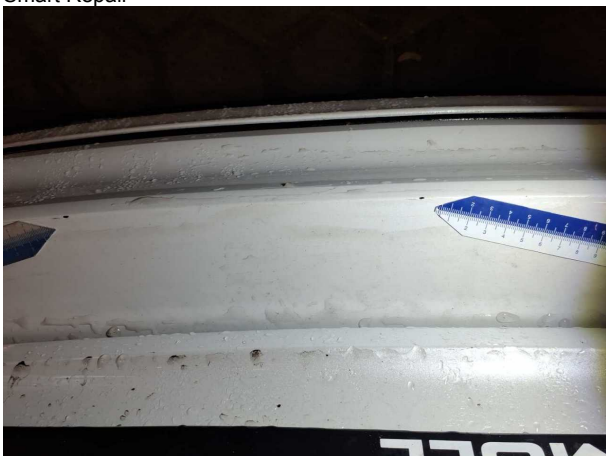
Beschädigung #2: Koffer: Ladekante - verkratzt / verschürft - Smart Repair
