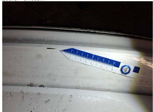
Beschädigung #2: Koffer: Ladekante - verkratzt / verschürft - Smart Repair
