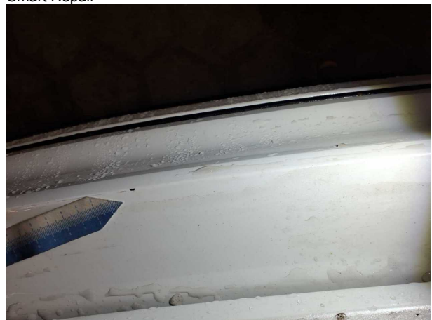
Beschädigung #2: Koffer: Ladekante - verkratzt / verschürft - Smart Repair
