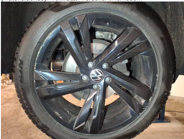
Beschädigung #4: Rad/Reifen: Leichtmetallfelge hinten rechts (Materialabrieb) - verkratzt / verschürft - erneuern
