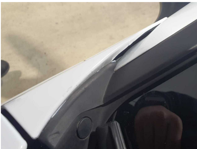
Damage 9: Mudguard - right side: Mudguard - right side (Wellig und lack löst sich) - Unprofessionally repaired - Paint
