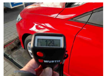
Lackstärke Kotflügel vorne links
