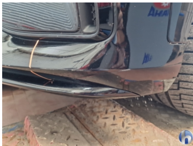
1. Stoßfänger Vorne Kratzer - Smart Repair
