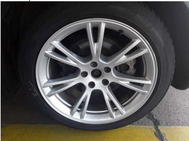
Beschädigung #7: Rad/Reifen: Leichtmetallfelge hinten links - verkratzt / verschürft - Wertminderung
