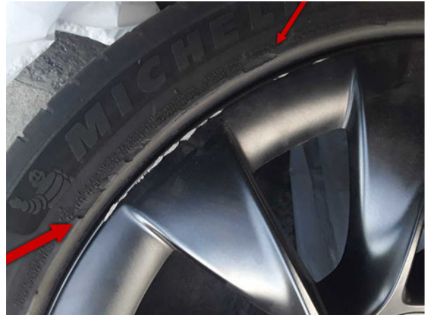
Beschädigung #9: 2.Radsatz: 1 Reifen - gebrochen / gerissen - erneuern
