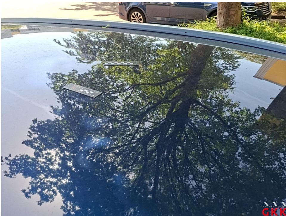
Bild 34. Dach, 4 bis 10 Dellen / Bauteil, kalt drücken
