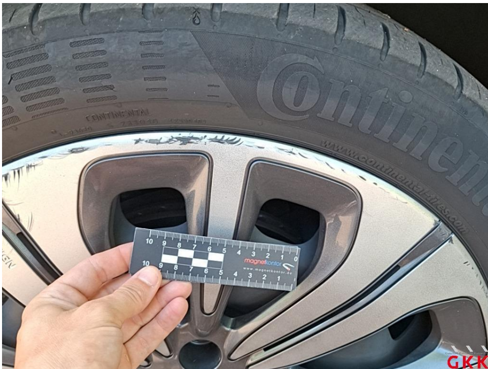
Bild 32. Radkappe(n), vorne rechts, beschädigt, ersetzen
