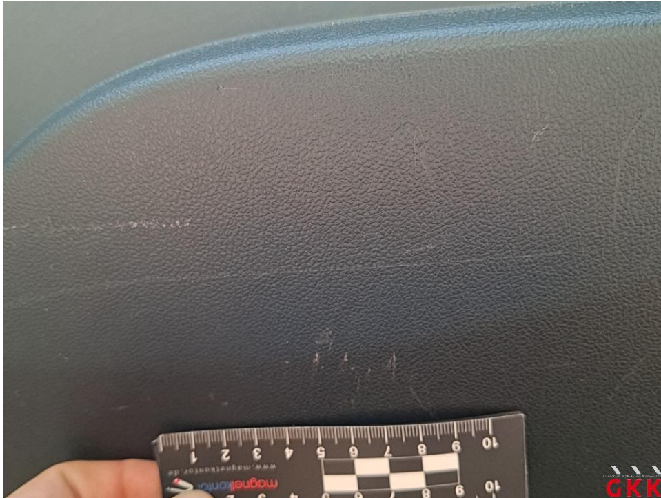
Bild 15. Heckklappe, Innenverkleidung, verkratzt, Smartrepair
