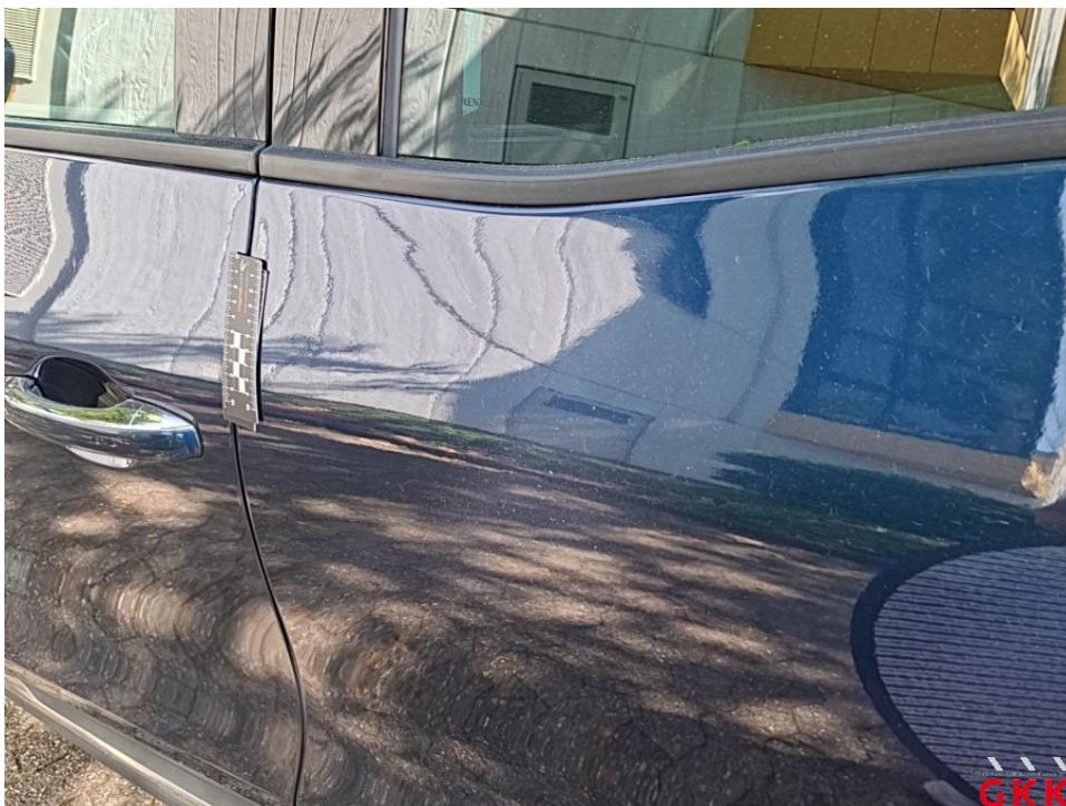
Bild 19. Tür hinten links, Reparaturmangel, lackieren
