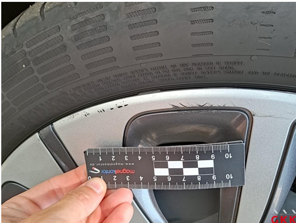
Bild 18. Radkappe(n), vorne links, beschädigt, ersetzen
