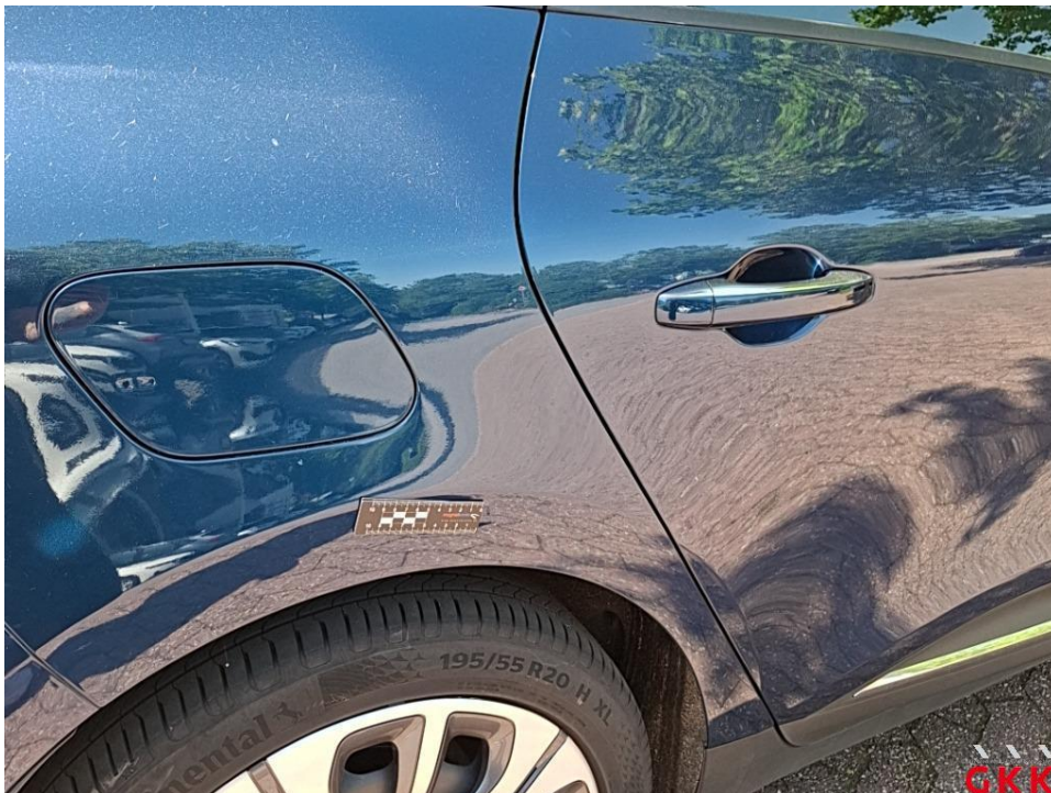
Bild 29. Seitenwand rechts, bis 3 Dellen / Bauteil, kalt drücken
