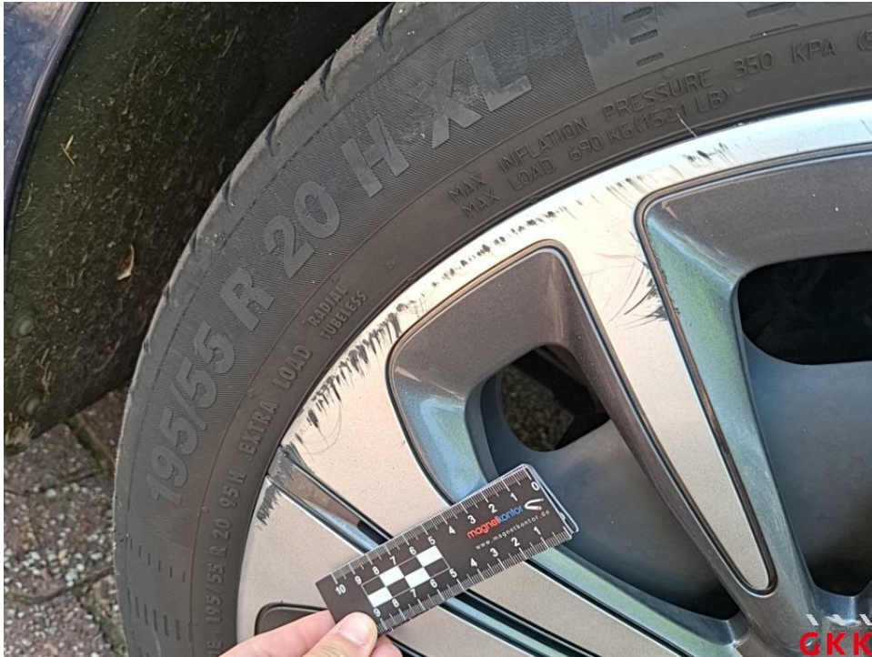
Bild 33. Radkappe(n), vorne rechts, beschädigt, ersetzen
