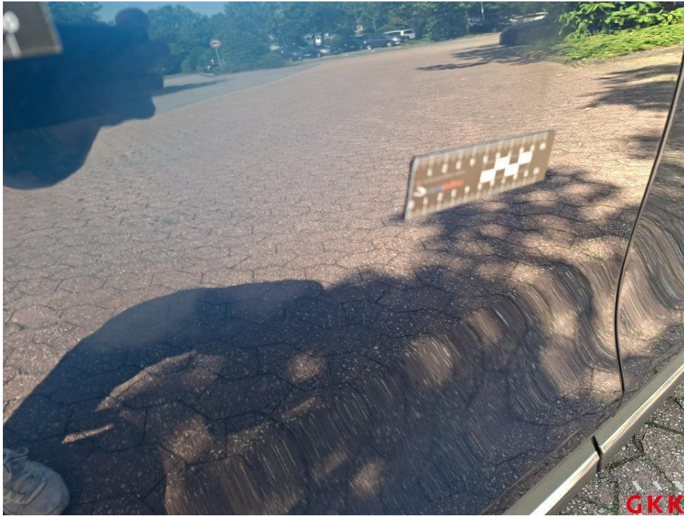
Bild 27. Tür hinten rechts, Reparaturmangel, lackieren
