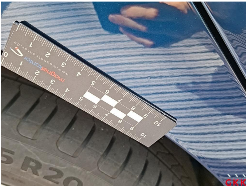
Bild 24. Seitenwand rechts, Reparaturmangel, lackieren
