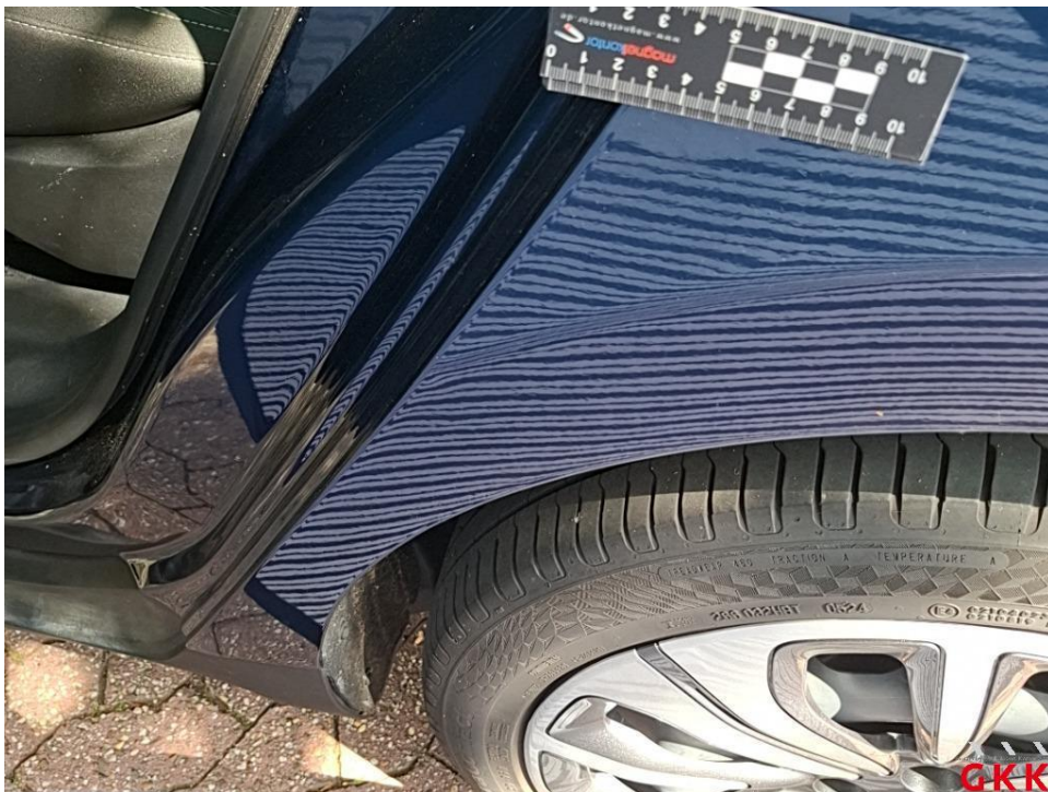
Bild 22. Seitenwand links, Reparaturmangel, instand setzen - lackieren
