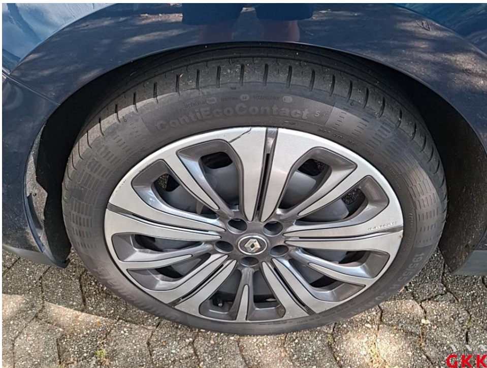
Bild 16. Radkappe(n), vorne links, beschädigt, ersetzen
