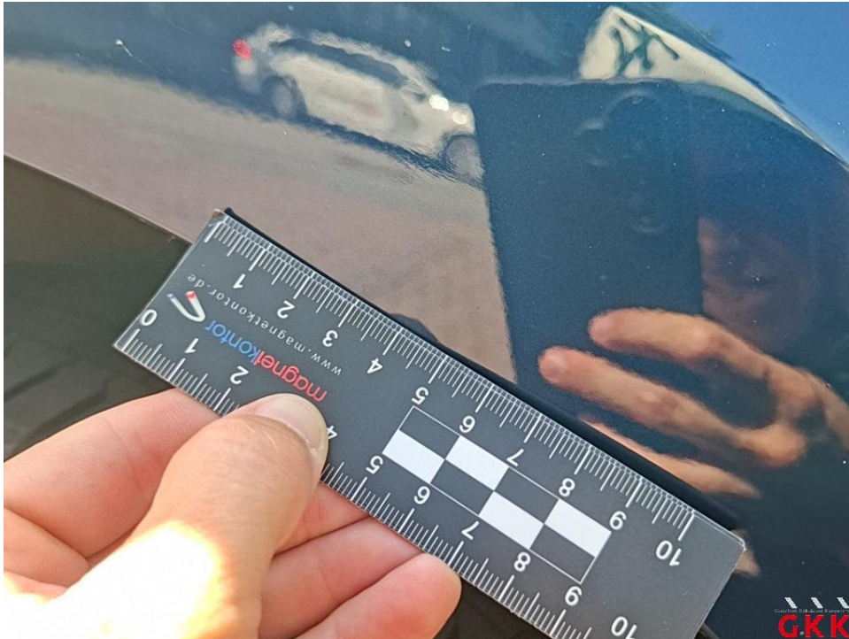
Bild 25. Seitenwand rechts, Reparaturmangel, lackieren
