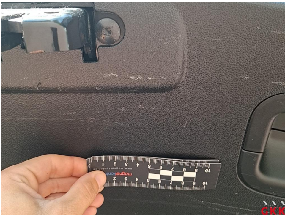
Bild 14. Heckklappe, Innenverkleidung, verkratzt, Smartrepair
