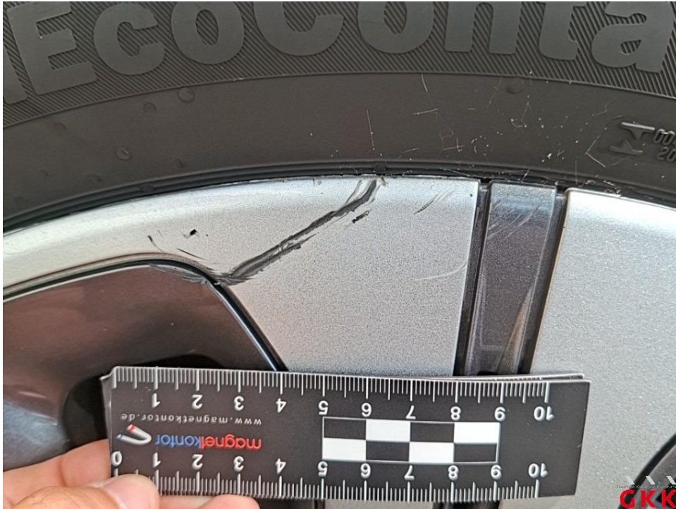
Bild 17. Radkappe(n), vorne links, beschädigt, ersetzen
