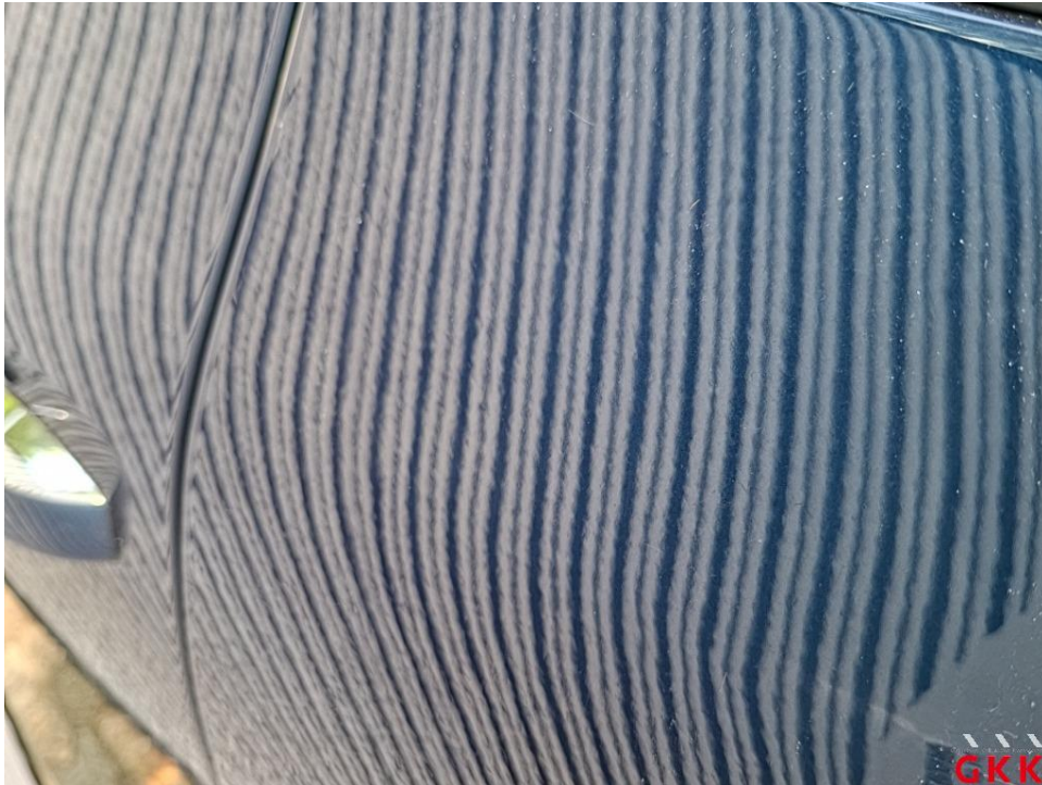
Bild 21. Tür hinten links, Reparaturmangel, lackieren
