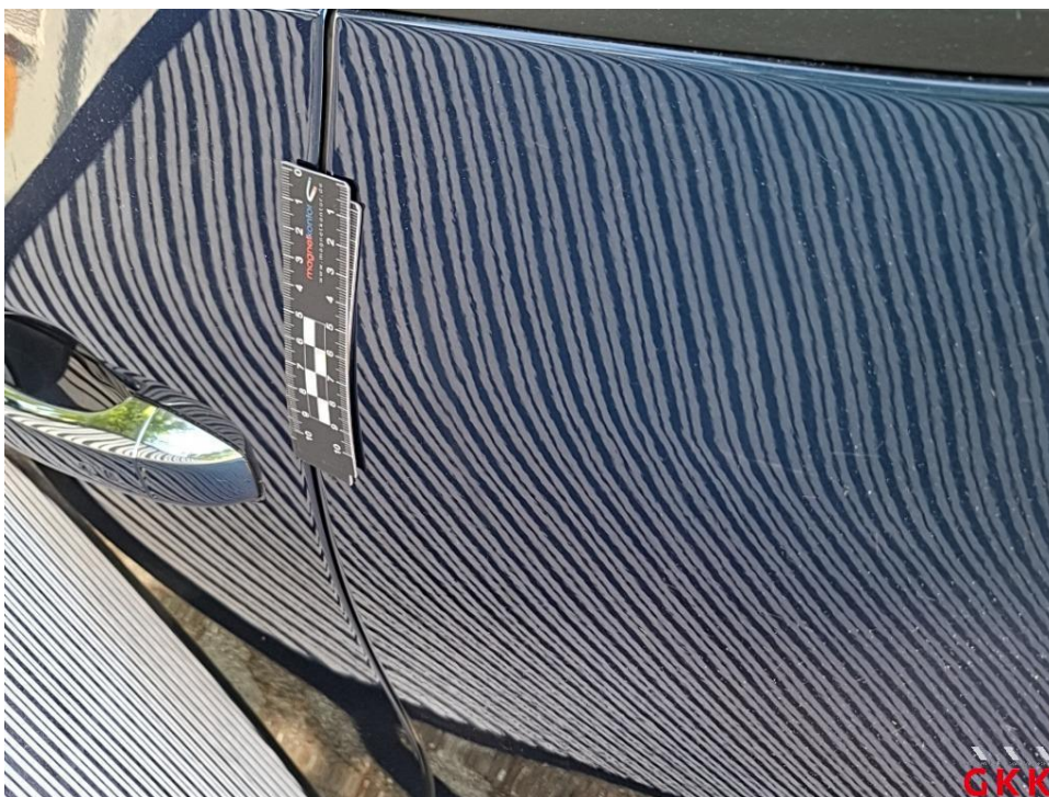
Bild 20. Tür hinten links, Reparaturmangel, lackieren
