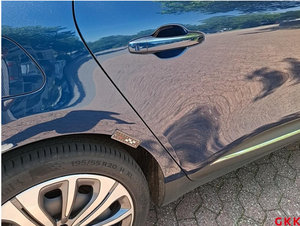
Bild 23. Seitenwand rechts, Reparaturmangel, lackieren
