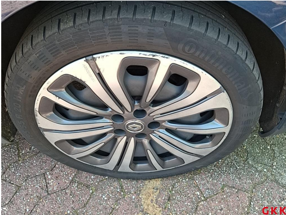
Bild 31. Radkappe(n), vorne rechts, beschädigt, ersetzen
