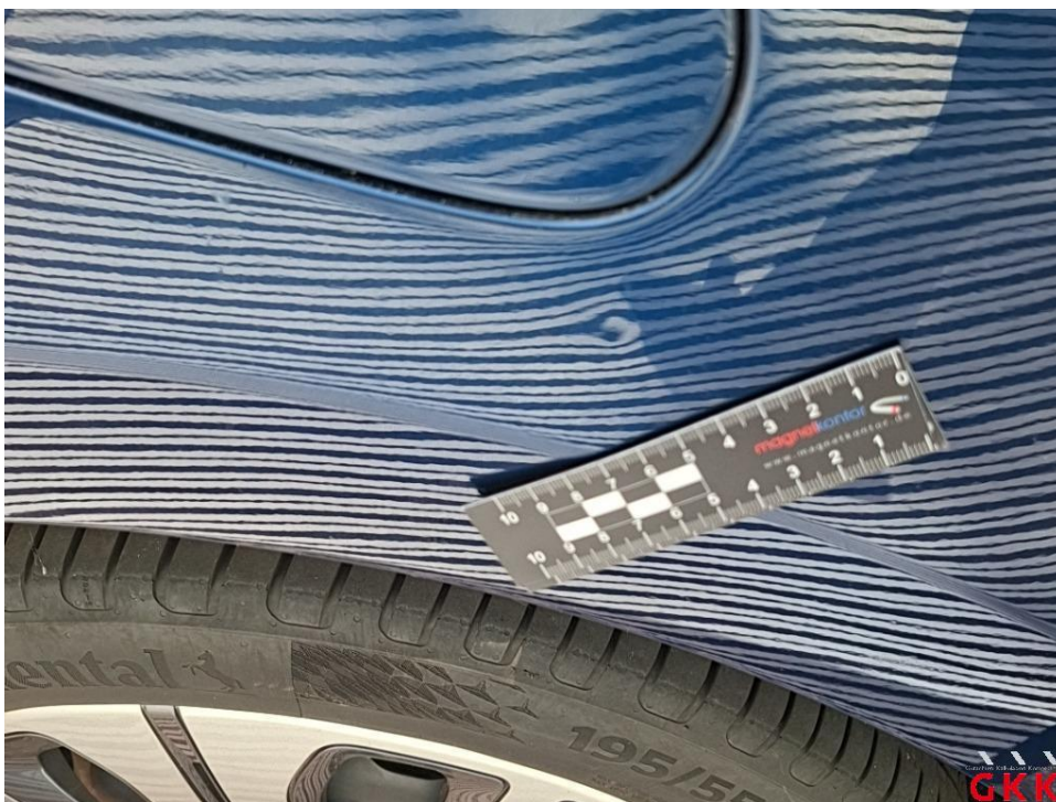
Bild 30. Seitenwand rechts, bis 3 Dellen / Bauteil, kalt drücken
