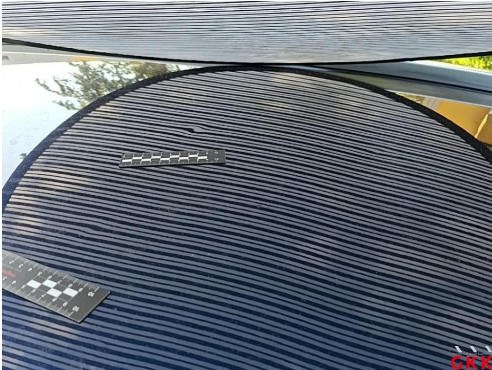
Bild 35. Dach, 4 bis 10 Dellen / Bauteil, kalt drücken
