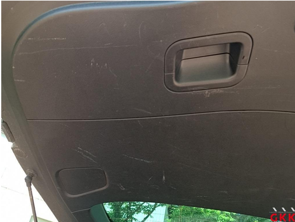
Bild 13. Heckklappe, Innenverkleidung, verkratzt, Smartrepair
