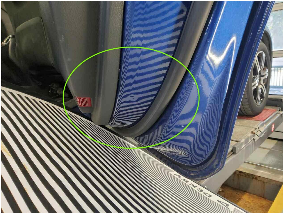
Bild 23 : Einstieg hinten rechts, mehrfach eingedellt mit Lackschaden, Tür hinten rechts innen, eingedellt
