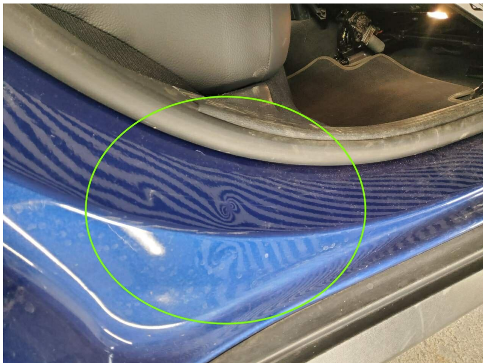
Bild 22 : Einstieg hinten rechts, mehrfach eingedellt mit Lackschaden
