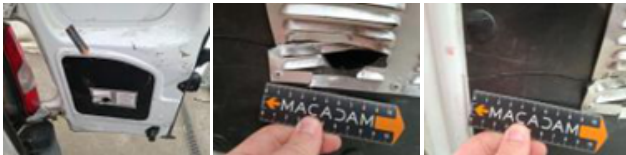
Joint de coffre, Déchirure, E - Remplacer
