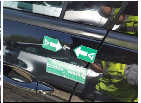
Porte / Avant Gauche / Enfoncement
