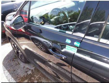
Porte / Avant Gauche / Enfoncement
