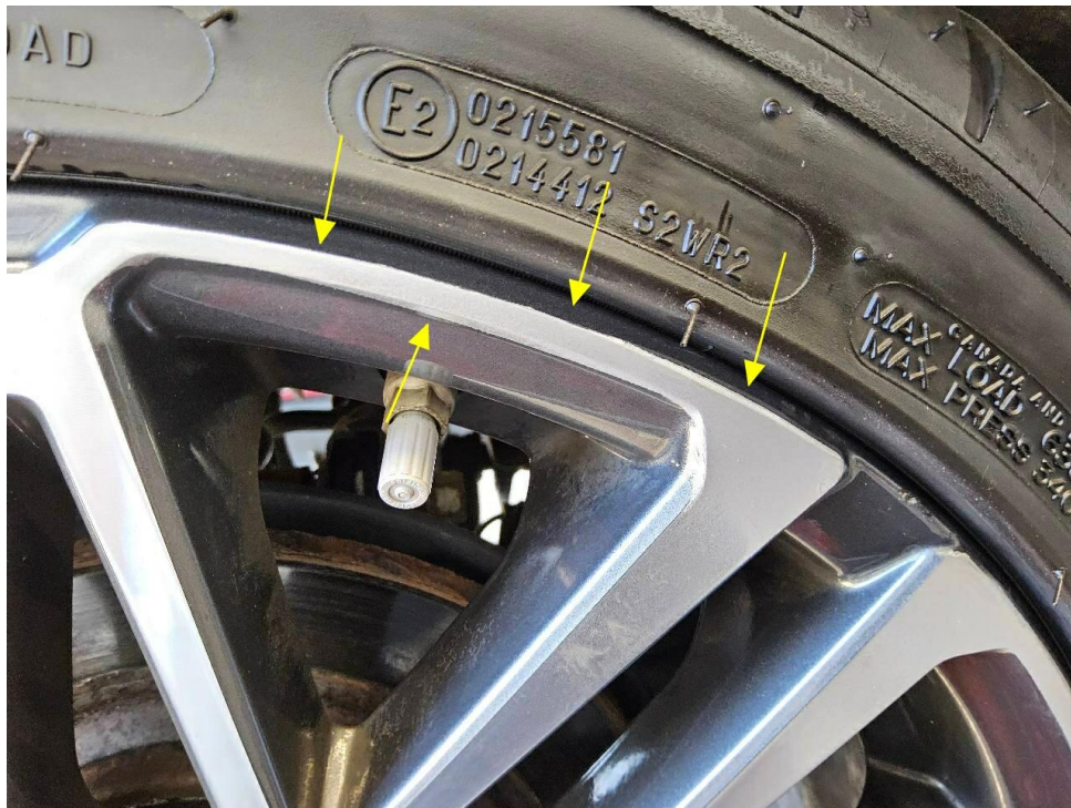
Bild 19 : Leichtmetallfelge hinten rechts Rückstände von Instandsetzung sichtbar
