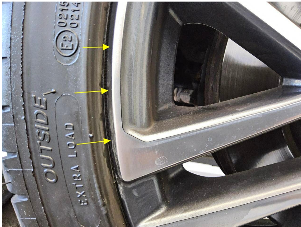
Bild 21 : Leichtmetallfelge Sommerräder vorn rechts, Rückstände von Instandsetzung sichtbar
