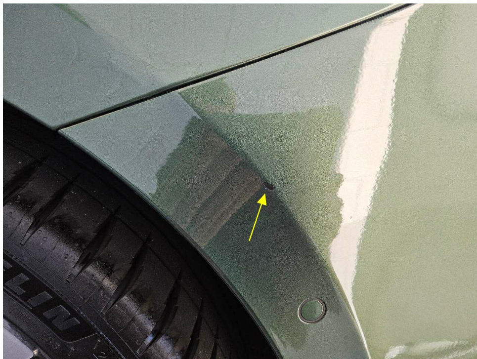
Bild 18 : Stoßfänger hinten verschrammt
