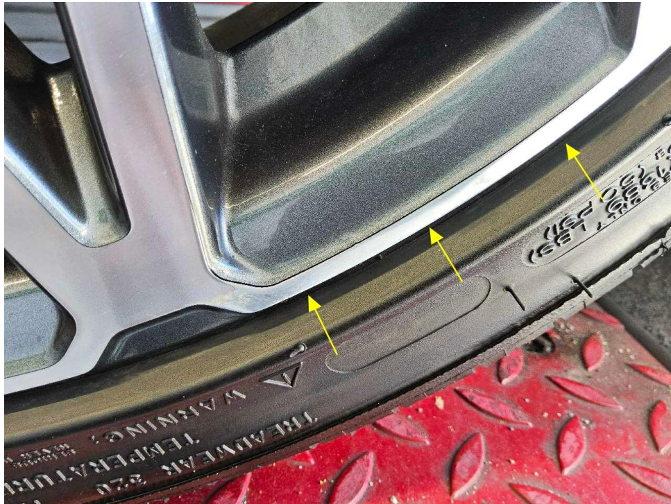
Bild 23 : Leichtmetallfelge Sommerräder hinten links, Rückstände von Instandsetzung sichtbar
