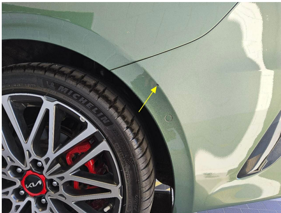
Bild 17 : Stoßfänger hinten verschrammt
