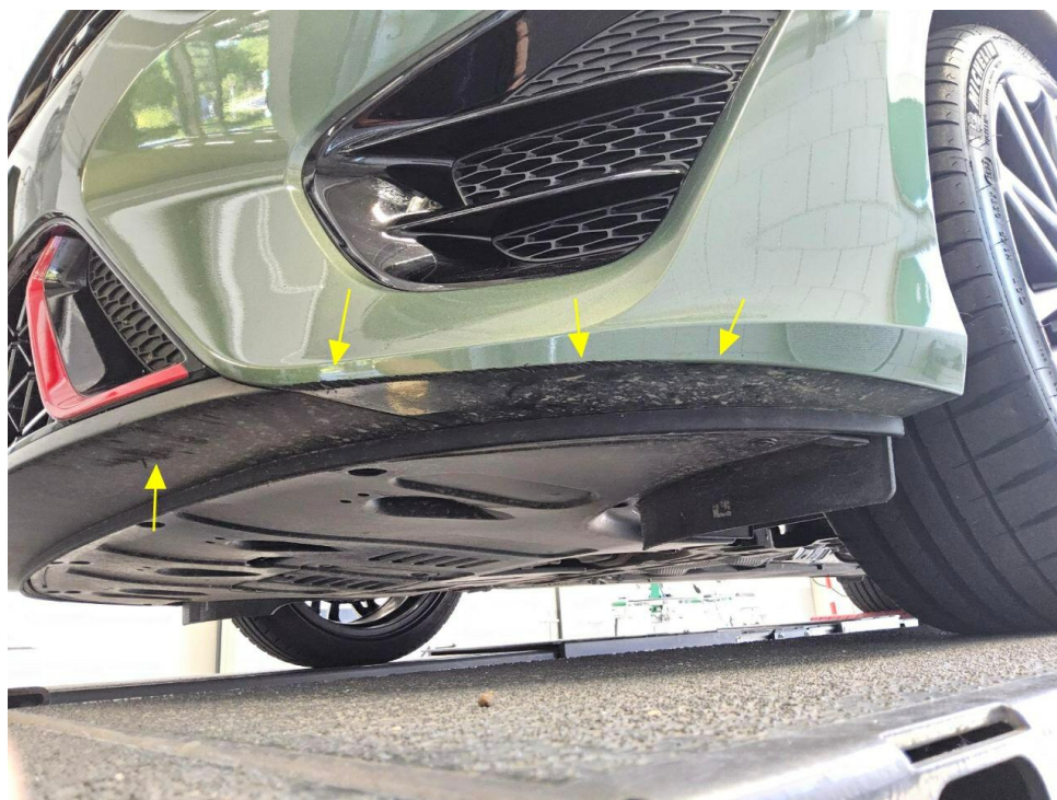
Bild 11 : Stoßfänger vorne, deformiert, instandsetzen und lackieren mit Lackaufbau
