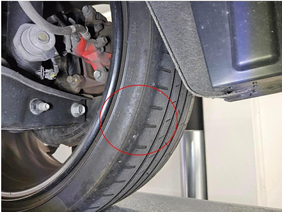
Bild 19 : Reifen Hinterachse Flanken abgefahren Abzug über Reifenpanel
