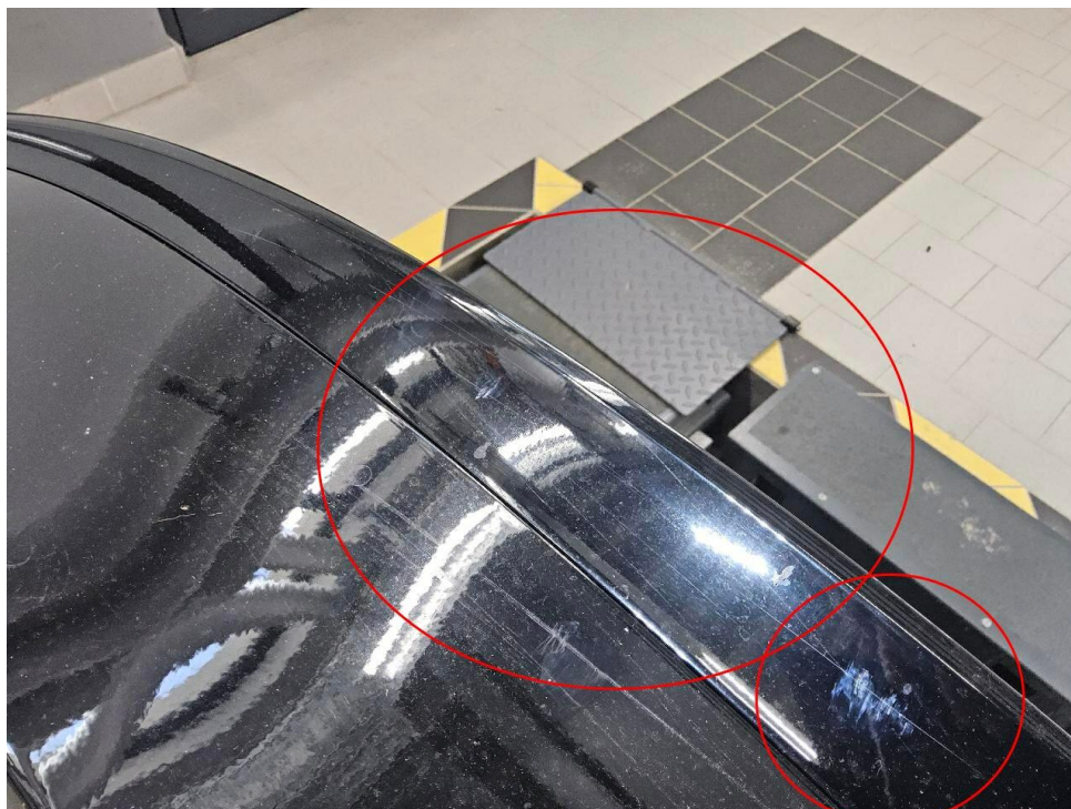
Bild 7 : Heckklappe Spoiler verkratzt
