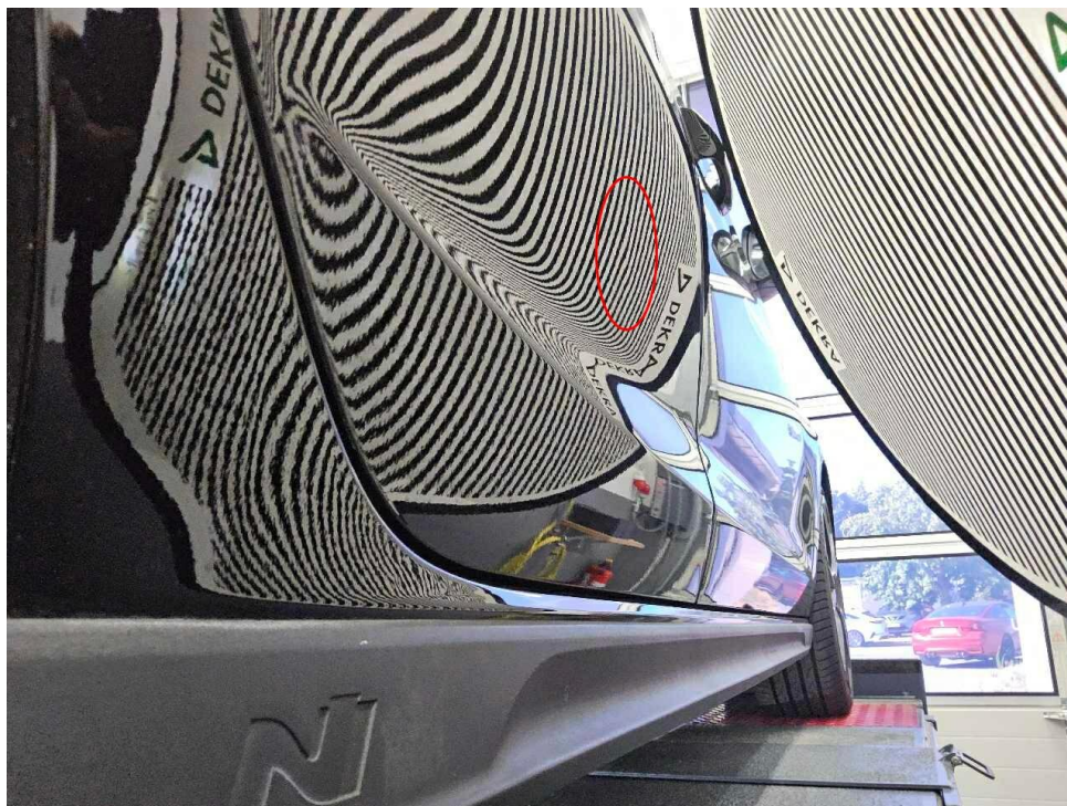
Bild 13 : Türe hinten rechts eingedellt
