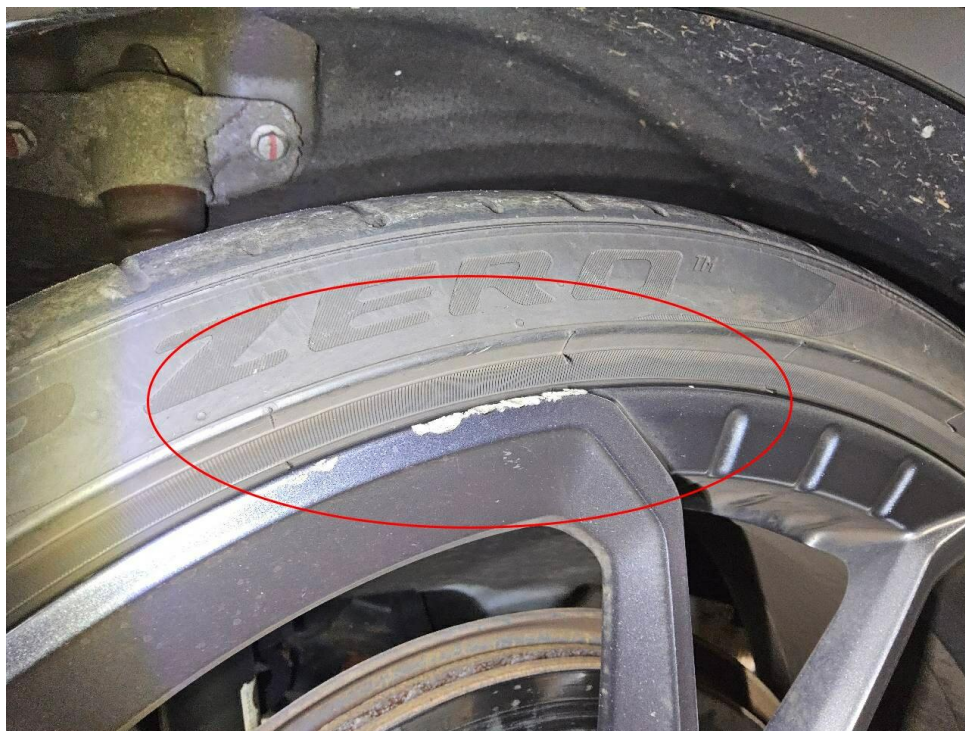
Bild 14 : Felge lackiert hinten rechts verschrammt
