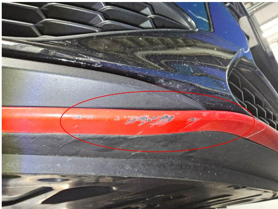
Bild 22 : Zierblende Stoßfänger vorne rechts verschrammt
