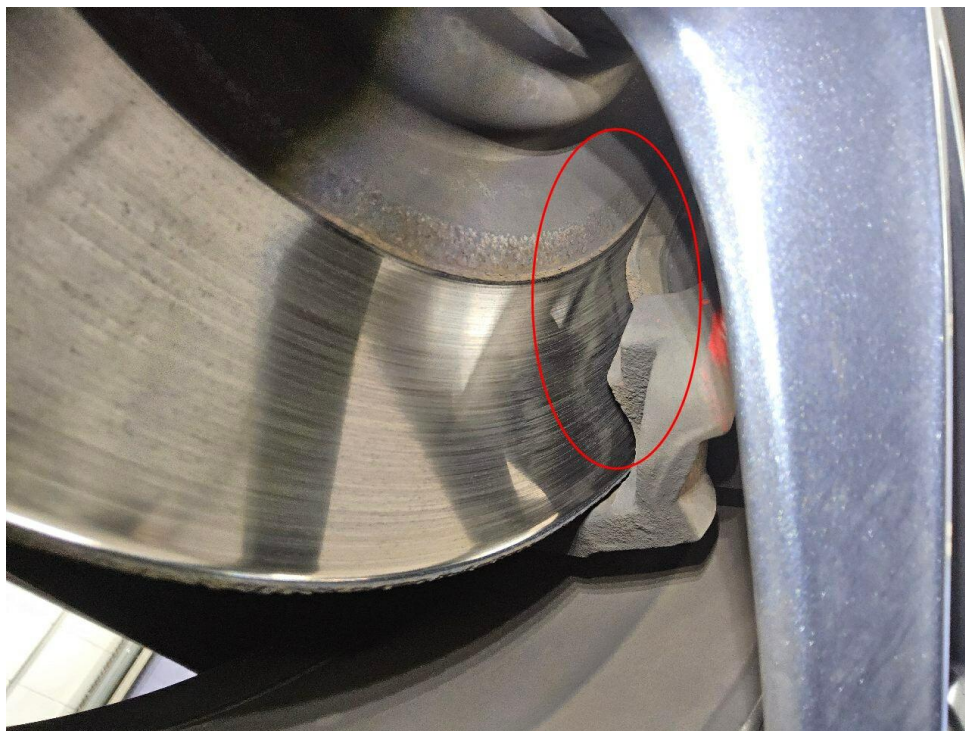
Bild 18 : Bremse vorne nahe Verschleißgrenze
