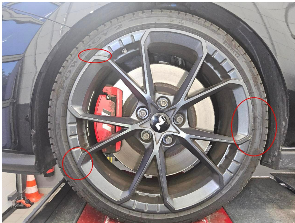
Bild 16 : Felge lackiert vorne links verschrammt
