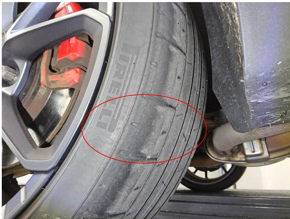
Bild 21 : Reifen Hinterachse Flanken abgefahren Abzug über Reifenpanel
