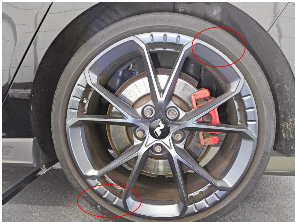
Bild 15 : Felge lackiert hinten links verschrammt
