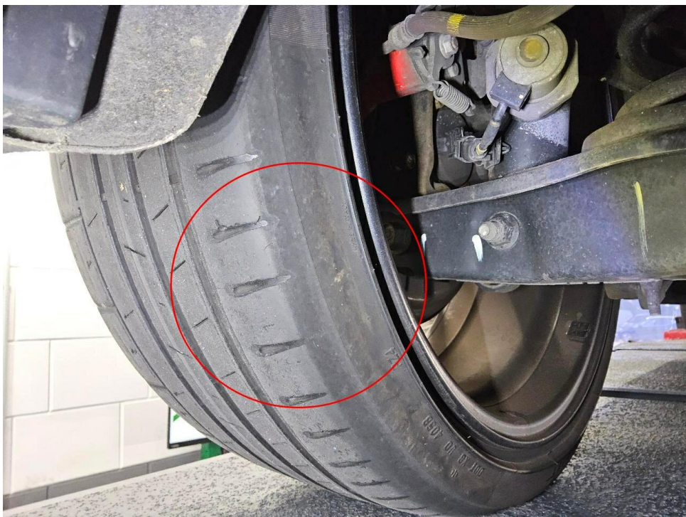
Bild 20 : Reifen Hinterachse Flanken abgefahren Abzug über Reifenpanel
