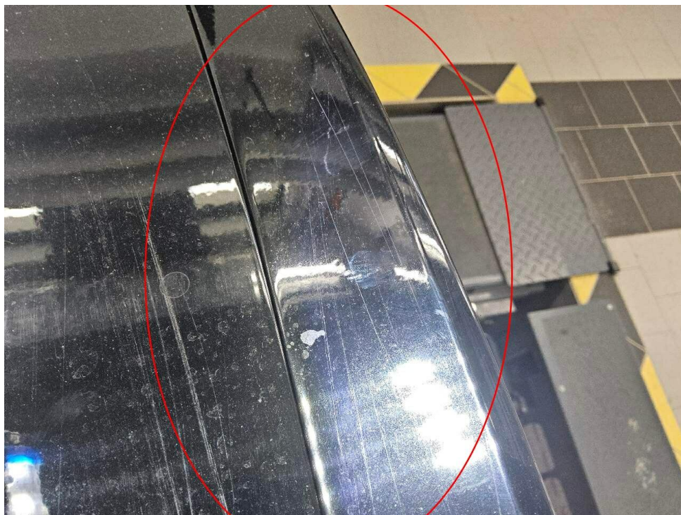
Bild 6 : Heckklappe Spoiler verkratzt
