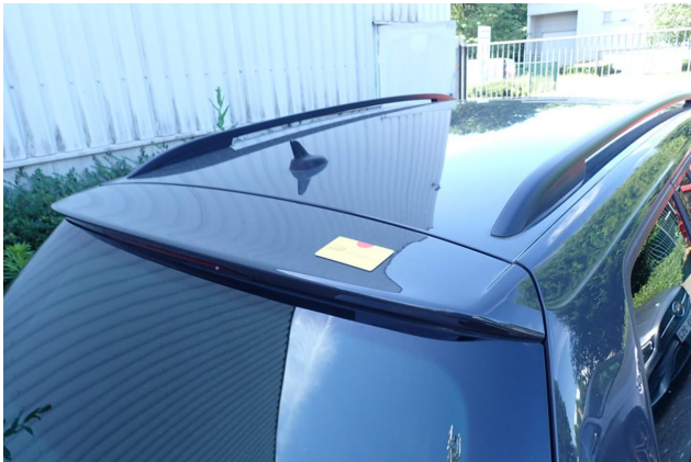
Gebrauchsspur 1: Heckklappe/-tür: Heckspoiler - Delle(n) - kein Abzug
