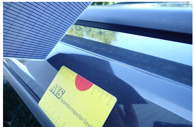
Gebrauchsspur 2: Fahrzeugdach: Dachholm links - Delle(n) - kein Abzug
