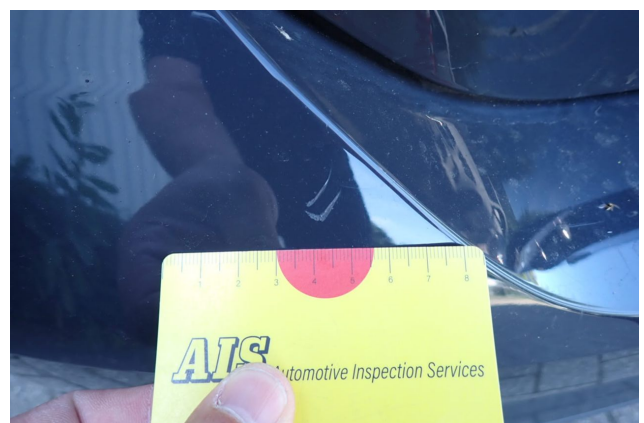
Beschädigung 6: Stossfänger hinten: Stossfänger hinten - verkratzt / verschürft - instandsetzen und lackieren
