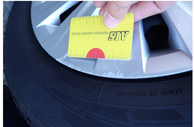
Beschädigung 4: Rad/Reifen: Radblende vorn rechts - verkratzt / verschürft - erneuern
