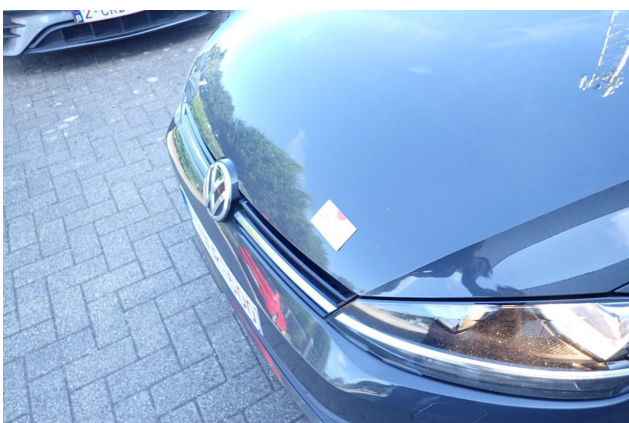
Gebrauchsspur 3: Motor: Motorabdeckung - Delle / Lackschaden - kein Abzug
