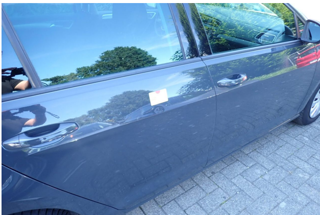
Beschädigung 5: Heckklappe/-tür: Hecktür rechts - Delle / Lackschaden - Smart Repair
