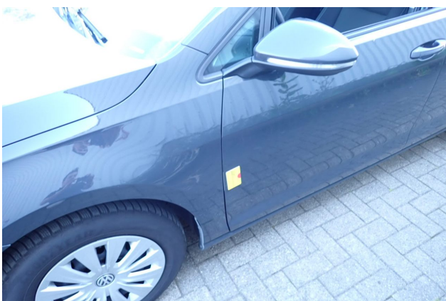
Beschädigung 3: Tür vorn links: Tür - Kratzer - Smart Repair
