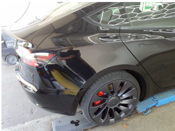
Beschädigung #6: Seitenwand rechts: Seitenwand - Kratzer - Smart Repair
