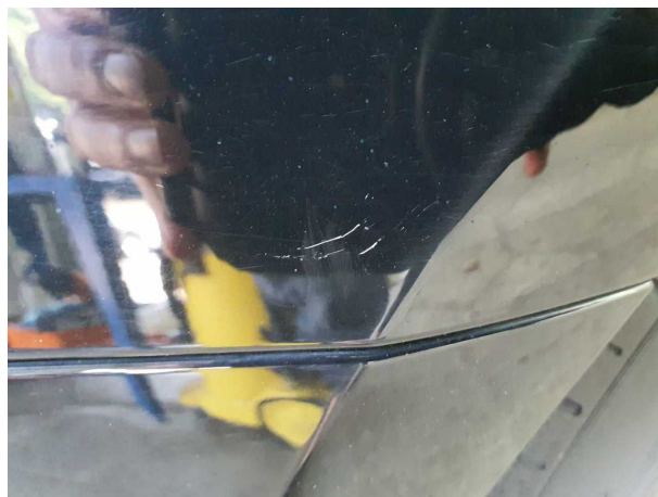
Beschädigung #6: Seitenwand rechts: Seitenwand - Kratzer - Smart Repair
