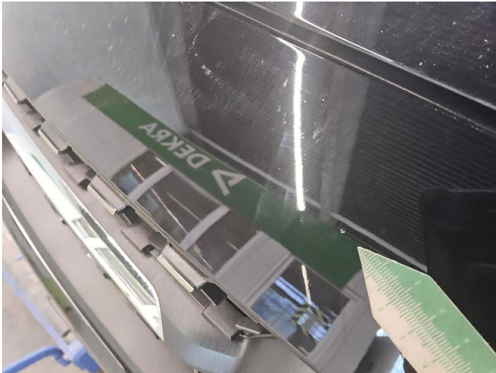
Bild 17 : Stoßfänger vorne Lackierung, Steinschlag, Gebrauchsspur
