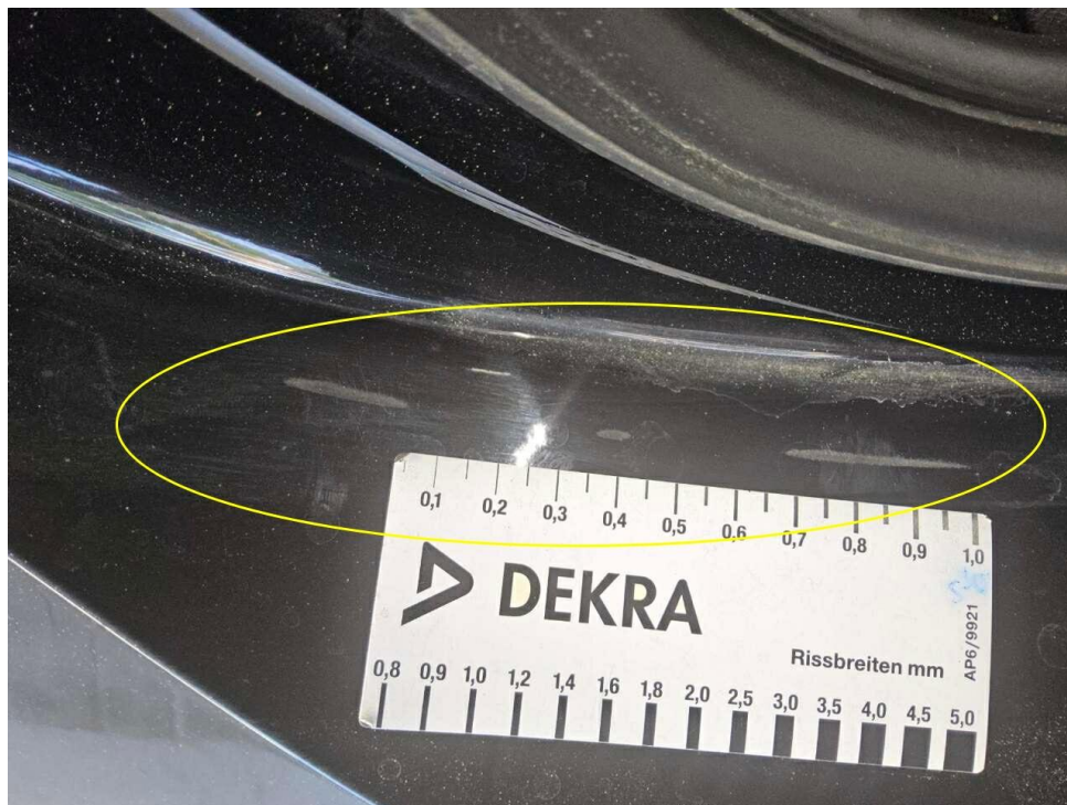
Bild 23 : Stoßfänger hinten Lackierung, zerkratzt, smart repair
