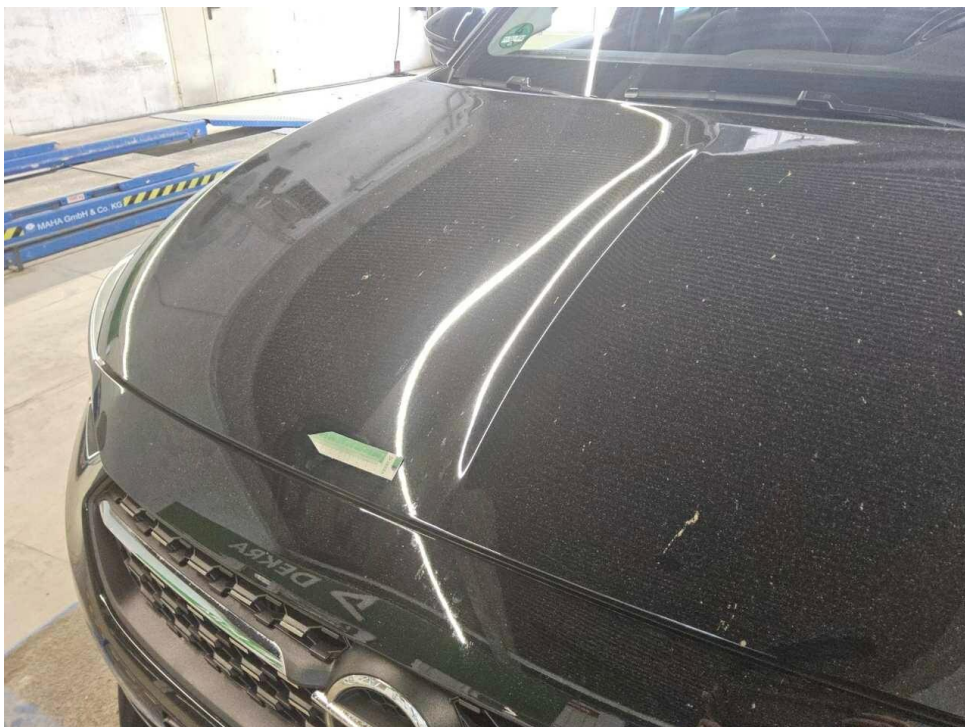
Bild 18 : Motorhaube Lackierung, Steinschlag, Gebrauchsspur
