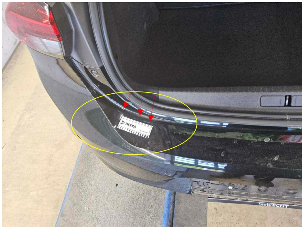
Bild 22 : Stoßfänger hinten Lackierung, zerkratzt, smart repair
