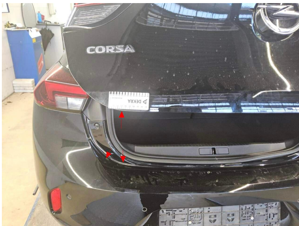
Bild 20 : Heckdeckel Kante, zerkratzt, smart repair
