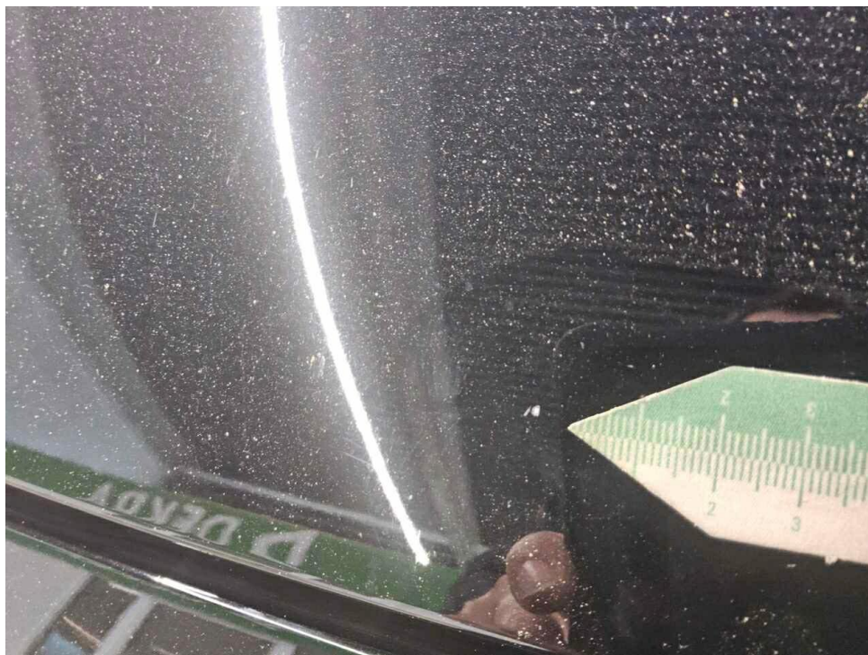
Bild 19 : Motorhaube Lackierung, Steinschlag, Gebrauchsspur
