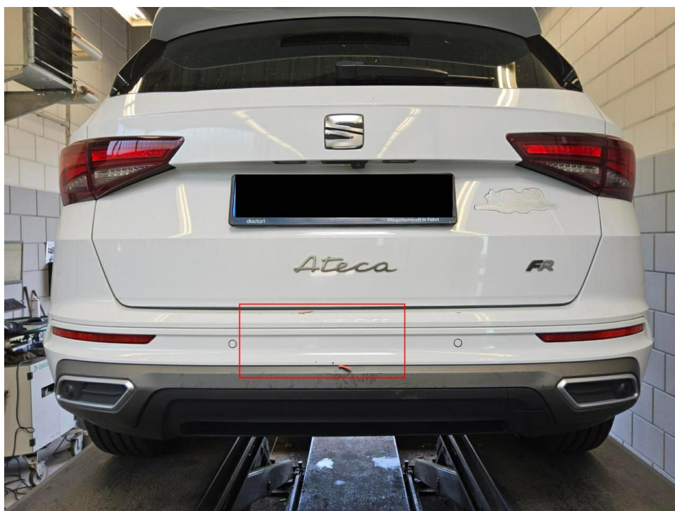
Bild 20 : Stoßfänger hinten Lackierung, zerkratzt, lackieren
