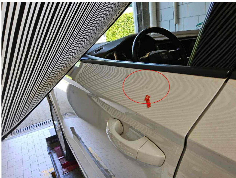
Bild 28 : Tür vorne links mehrfach eingedellt
