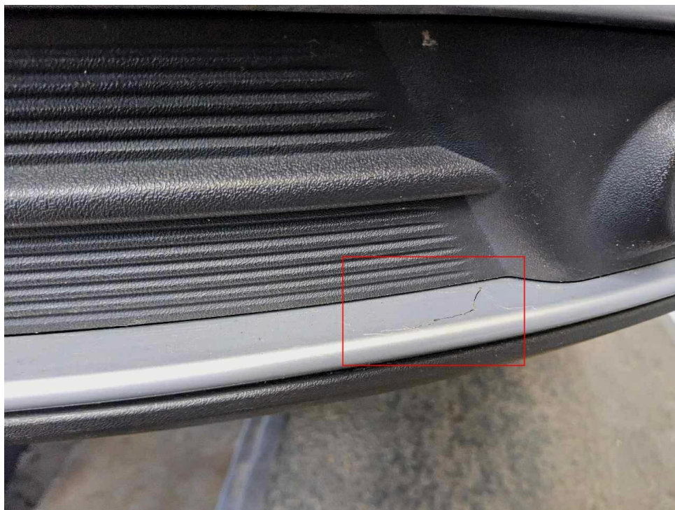
Bild 25 : Stoßfängerverkleidung hinten, Zierblende rechts gerissen
