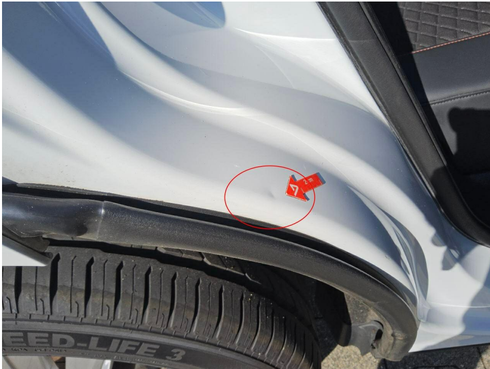
Bild 33 : Türeinstieg hinten rechts eingedellt
