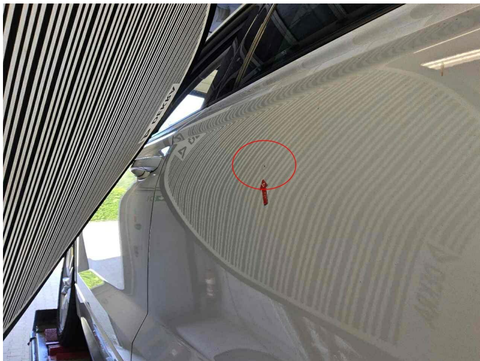
Bild 30 : Tür hinten links eingedellt
