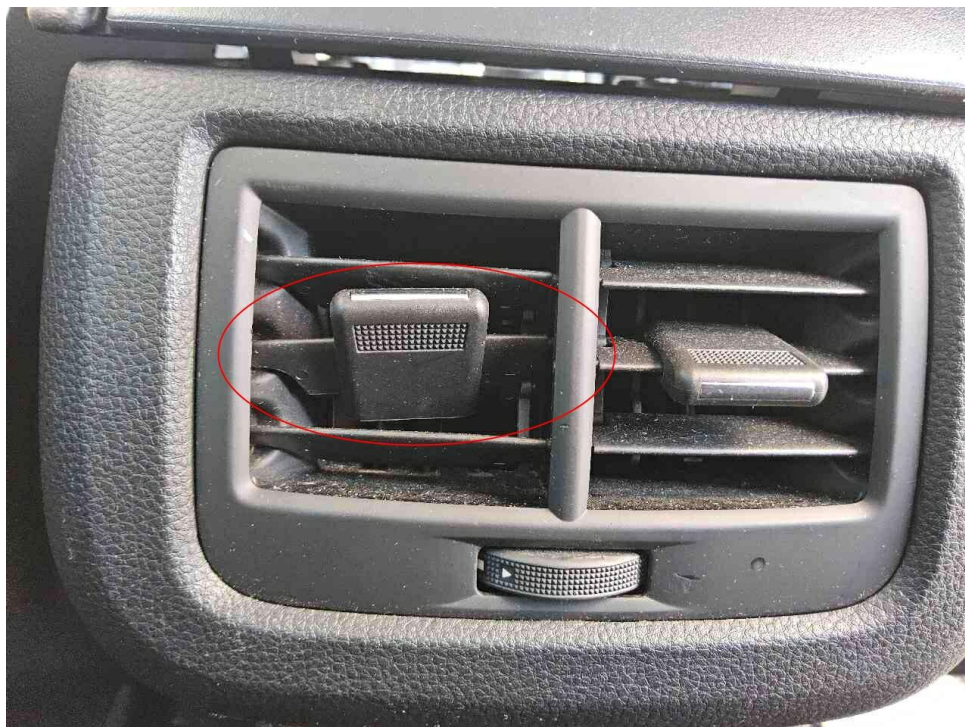
Bild 36 : Belüftungsdüse hinten zerbrochen
