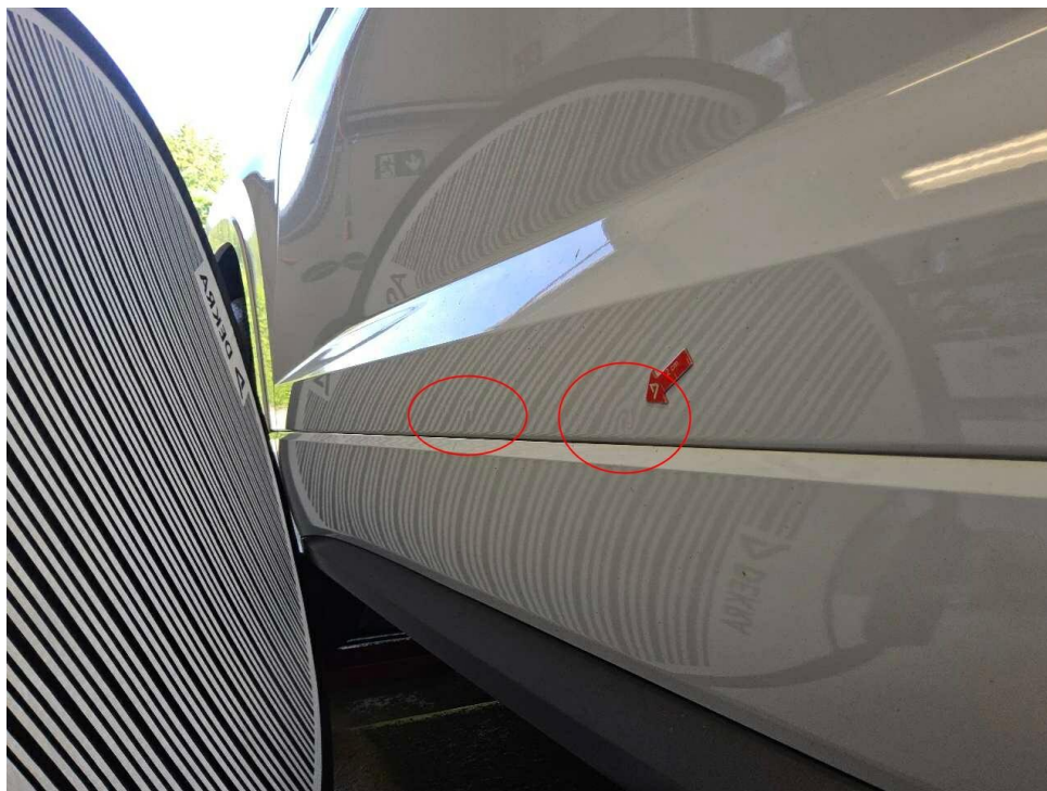
Bild 29 : Tür vorne links mehrfach eingedellt
