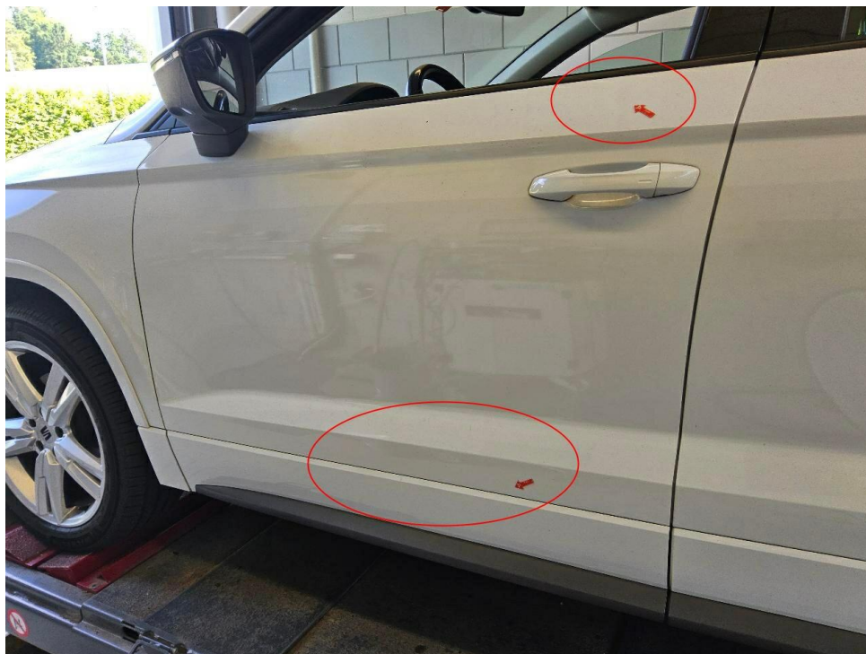
Bild 27 : Tür vorne links mehrfach eingedellt
