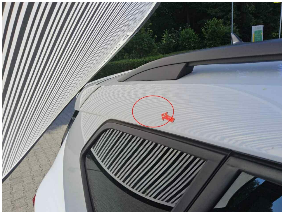
Bild 32 : Dachrahmen rechts eingedellt
