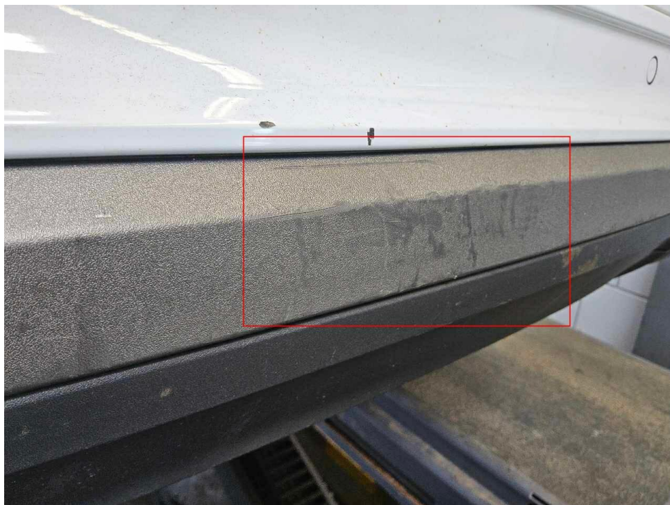
Bild 24 : Stoßfängerverkleidung hinten, Unterteil deformiert
