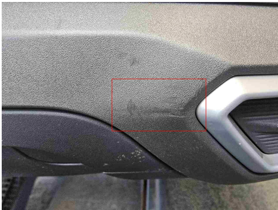
Bild 23 : Stoßfängerverkleidung hinten, Unterteil deformiert
