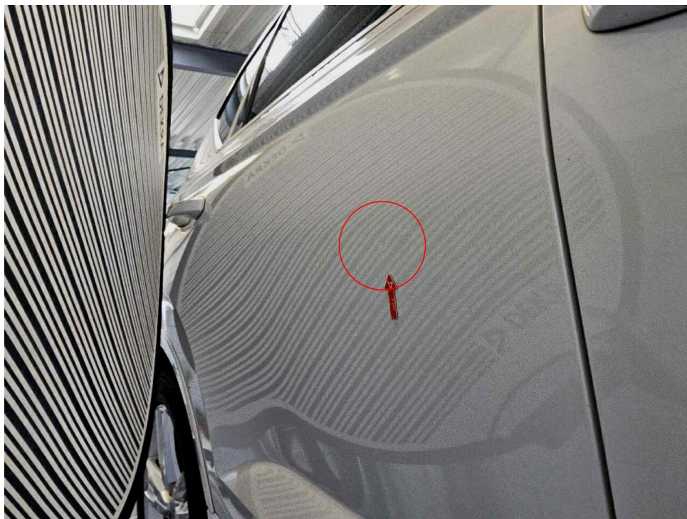
Bild 31 : Tür hinten rechts eingedellt
