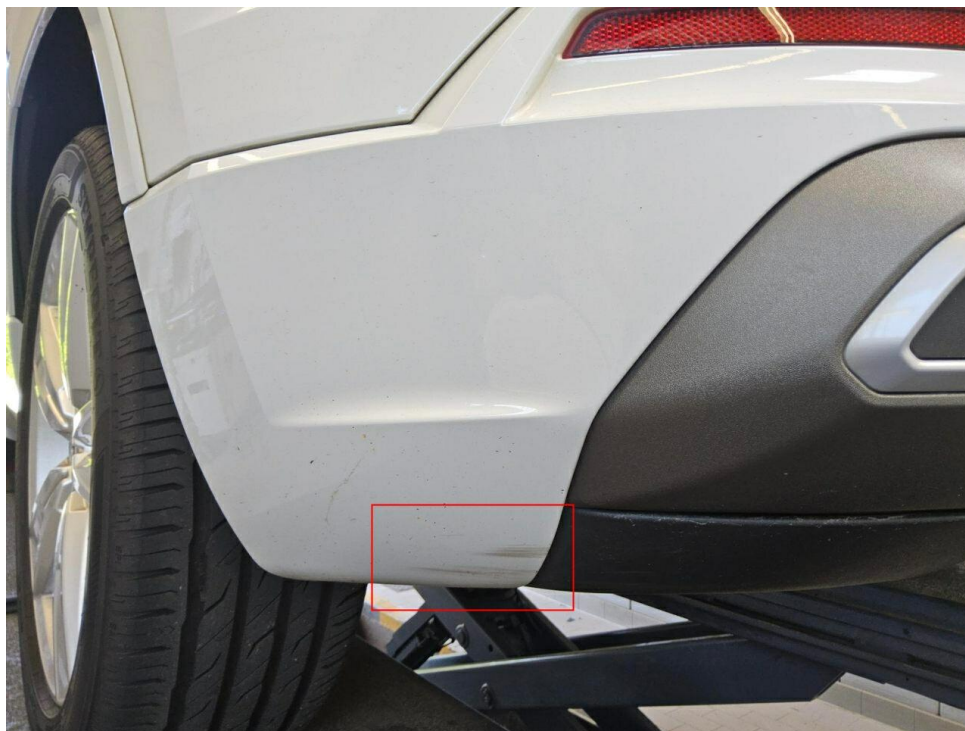
Bild 22 : Stoßfänger hinten Lackierung, zerkratzt, lackieren
