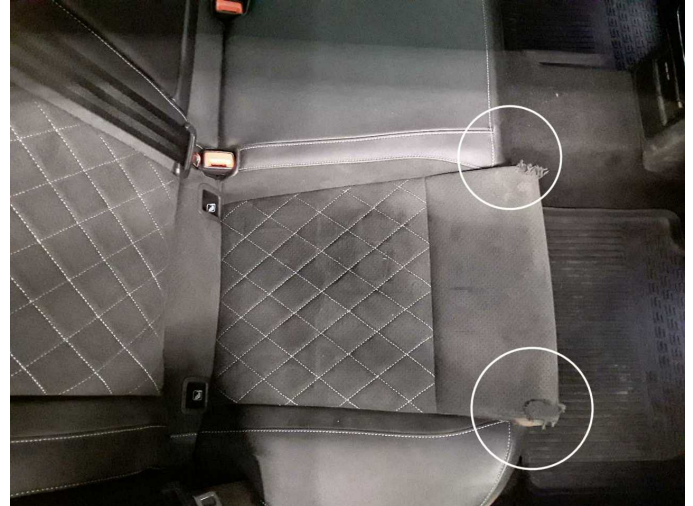
Damage 9: Seat - rear: Back seat (Rechts außen, Sitzbezug komplett) - Broken / torn - Replace
