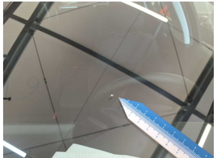
Damage 2: Vehicle glazing: Windscreen (Im Fahrersichtfeld) - Stone chips - Replace
