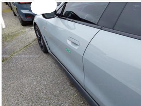
Porte / Avant Gauche / Enfoncement
