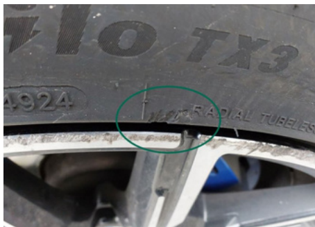
Pneu / Avant Gauche / Déchiré
