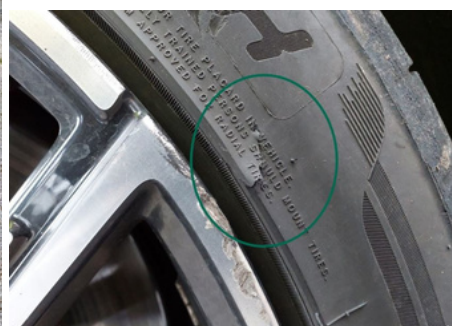
Pneu / Avant Droit / Déchiré
