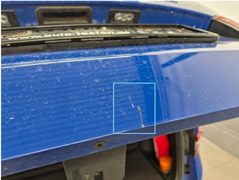
Bild 17 : Heckklappe Lackierung, zerkratzt, smart repair
