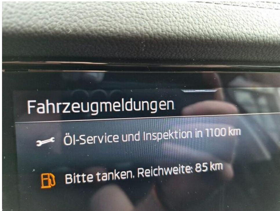
Bild 15 : Ölwechsel und Inspektion in 1100 Km fällig
