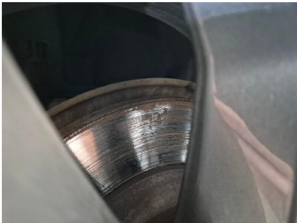
Bild 23 : Bremsscheiben Hinterachse Flugrost
