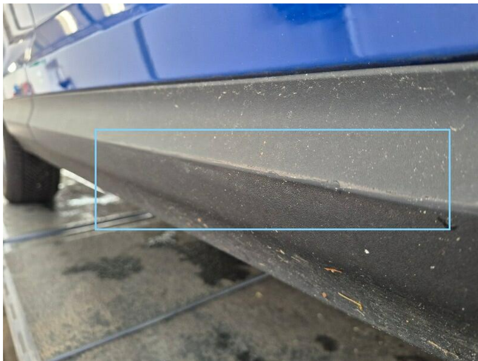
Bild 20 : Tür vorne rechts Schutzleiste unten, zerkratzt, smart repair
