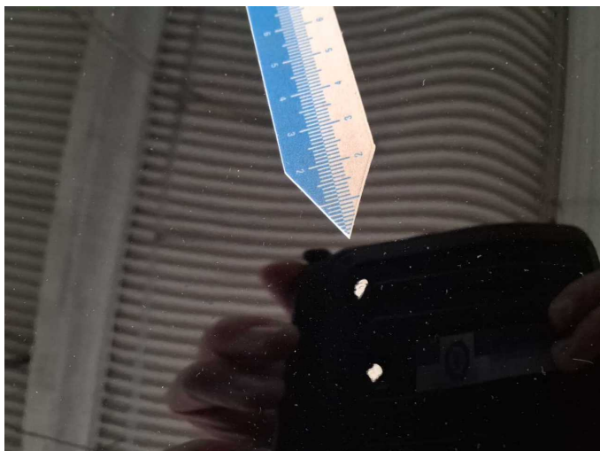
Damage 12: Bonnet: Bonnet (+ Einätzungen) - Stone chips - Paint
