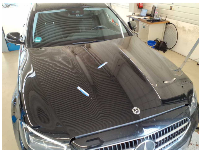
Damage 12: Bonnet: Bonnet (+ Einätzungen) - Stone chips - Paint
