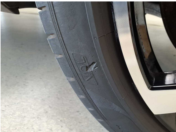
Beschädigung #11: Rad/Reifen: Reifen vorn rechts - gebrochen / gerissen - erneuern
