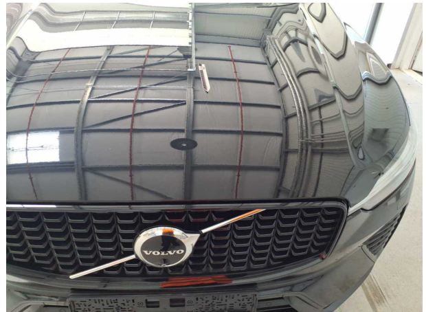
Beschädigung #18: Motorhaube: Motorhaube - verkratzt / verschürft - lackieren
