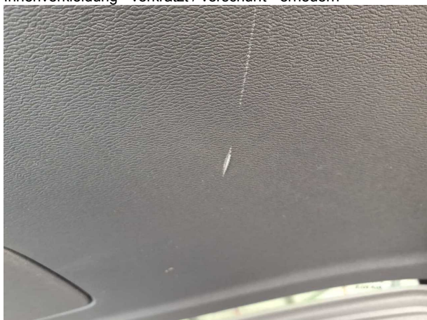
Beschädigung #8: Verkleidungen/Abdeckungen: Heckdeckel, Innenverkleidung - verkratzt / verschürft - erneuern
