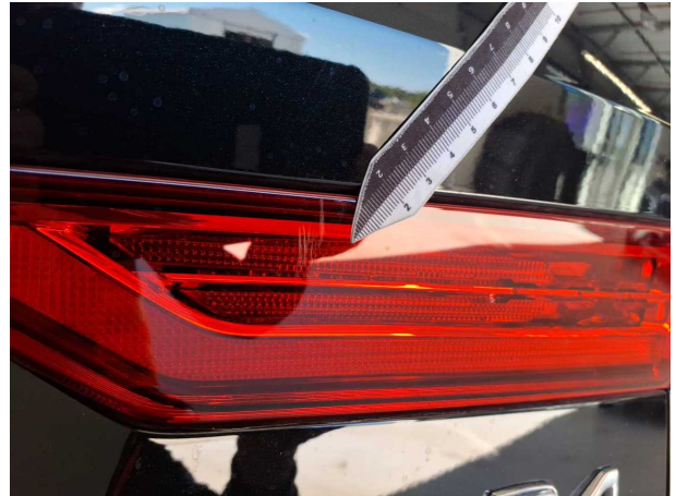
Beschädigung #9: Heckleuchte: Heckleuchte rechts - verkratzt / verschürft - erneuern
