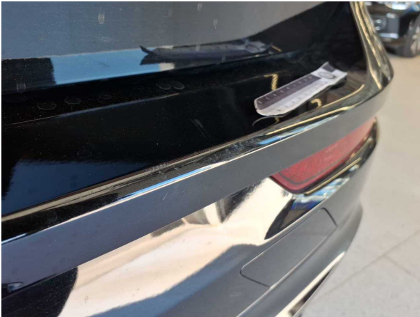
Beschädigung #22: Stossfänger hinten: Stossfänger hinten (inkl. Zierleiste Mitte lackieren & Zierblende unten erneuern) - verkratzt /
