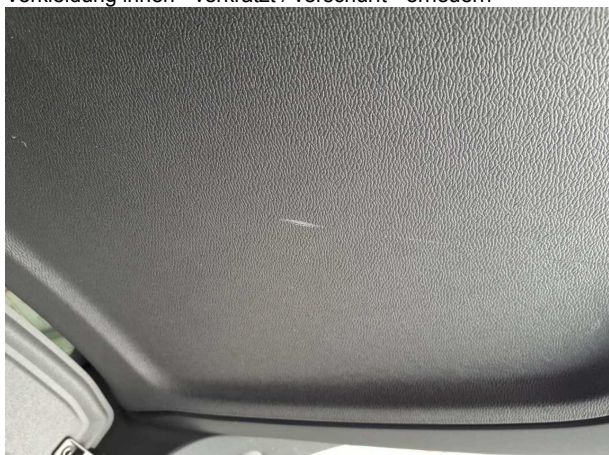
Beschädigung #8: Verkleidungen/Abdeckungen: Heckdeckel, Innenverkleidung - verkratzt / verschürft - erneuern
