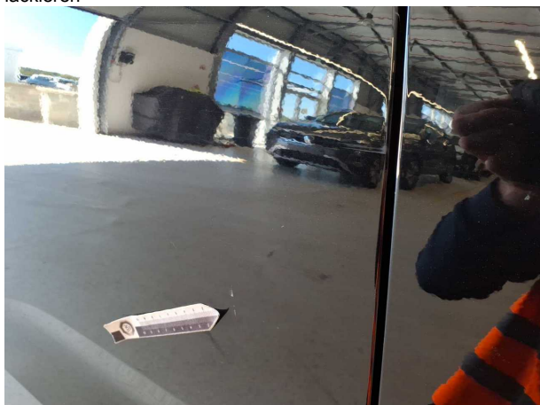
Beschädigung #16: Tür hinten rechts: Tür - verkratzt / verschürft - lackieren
