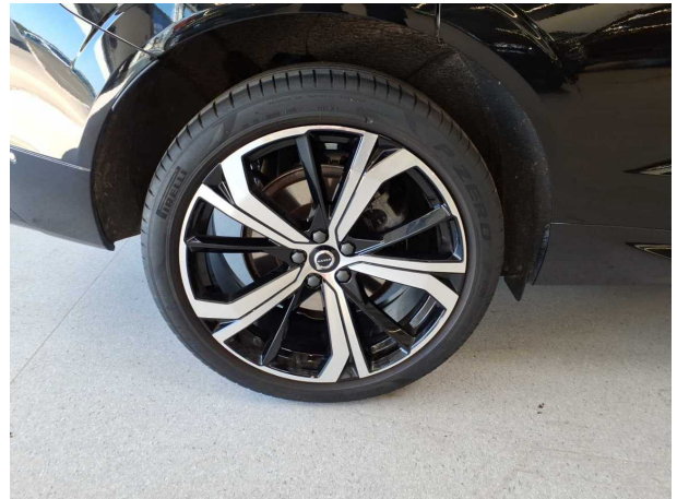
Beschädigung #15: Rad/Reifen: Leichtmetallfelge hinten rechts - verkratzt / verschürft - erneuern
