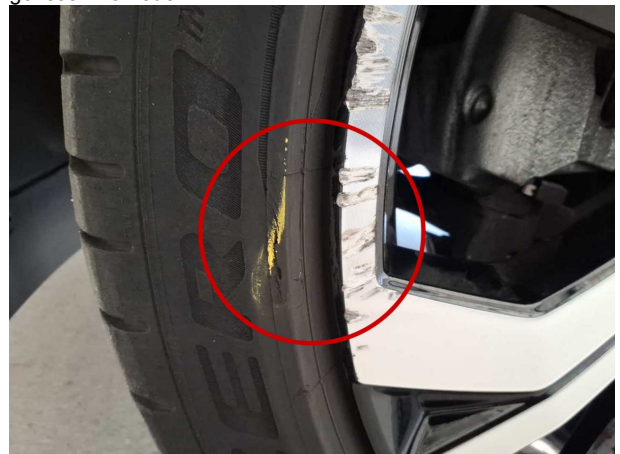
Beschädigung #12: Rad/Reifen: Reifen vorn links - gebrochen / gerissen - erneuern
