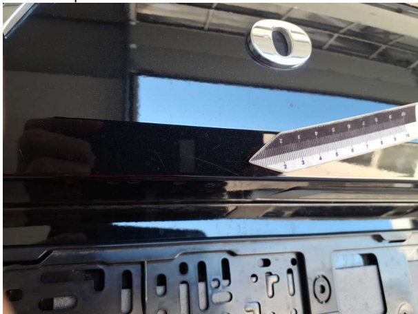
Beschädigung #2: Heckklappe/-tür: Heckklappe - verkratzt / verschürft - Smart Repair
