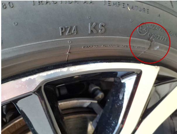
Beschädigung #13: Rad/Reifen: Reifen hinten rechts - gebrochen / gerissen - erneuern
