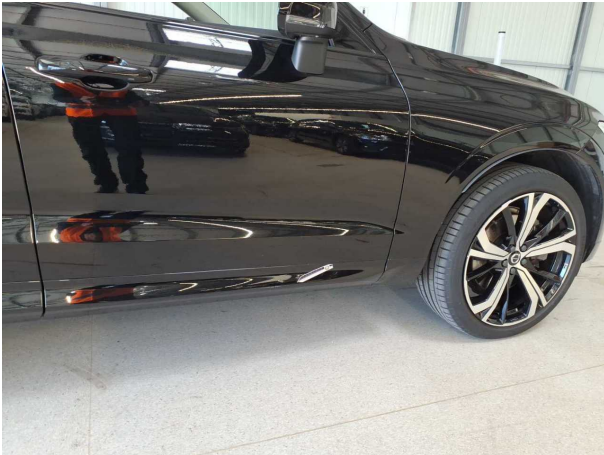
Beschädigung #21: Tür vorn rechts: Tür (inkl. Zierleiste erneuern) - verkratzt / verschürft - lackieren
