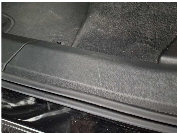
Beschädigung #7: Verkleidungen/Abdeckungen: C-Säule links Verkleidung innen - verkratzt / verschürft - erneuern
