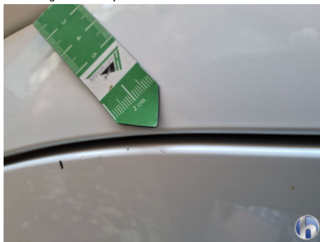
2. Seitenwand - Hinten - Links Kratzer - Smart Repair
