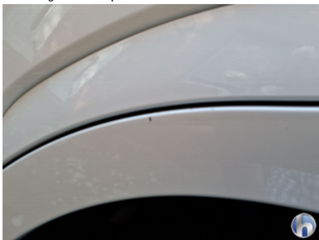
2. Seitenwand - Hinten - Links Kratzer - Smart Repair
