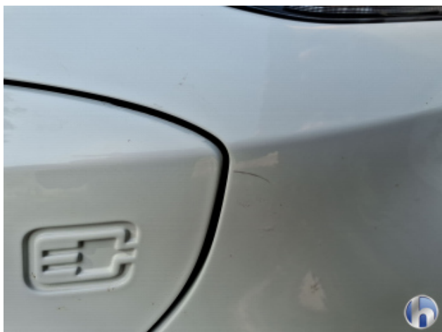
7. Ladeklappe Kratzer - Smart Repair
