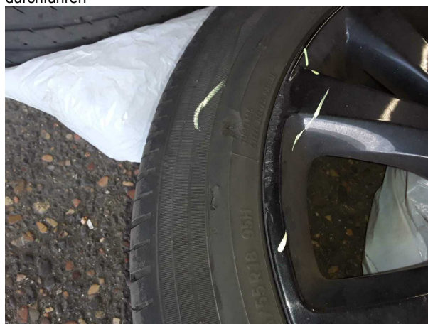
Beschädigung #3: 2.Radsatz: 1 Reifen - beschädigt - erneuern
