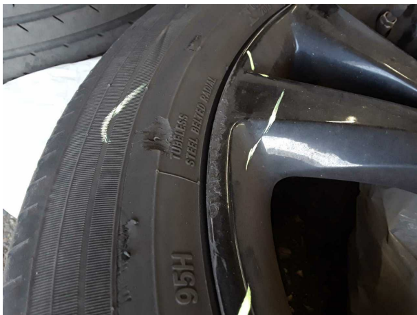
Beschädigung #4: 2.Radsatz: 1 Leichtmetallfelge - verkratzt / verschürft - erneuern
