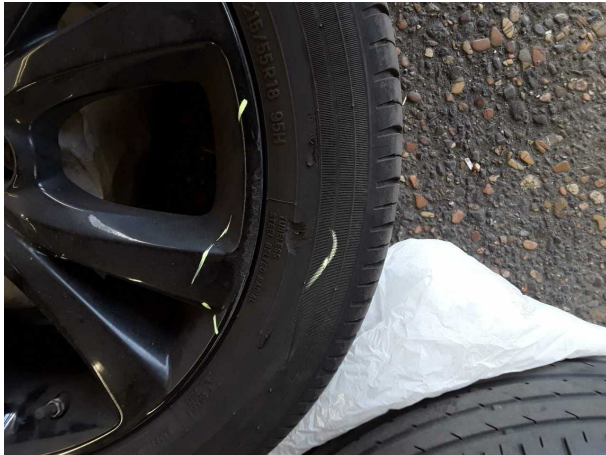
Beschädigung #3: 2.Radsatz: 1 Reifen - beschädigt - erneuern
