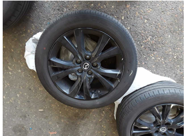
Beschädigung #4: 2.Radsatz: 1 Leichtmetallfelge - verkratzt / verschürft - erneuern
