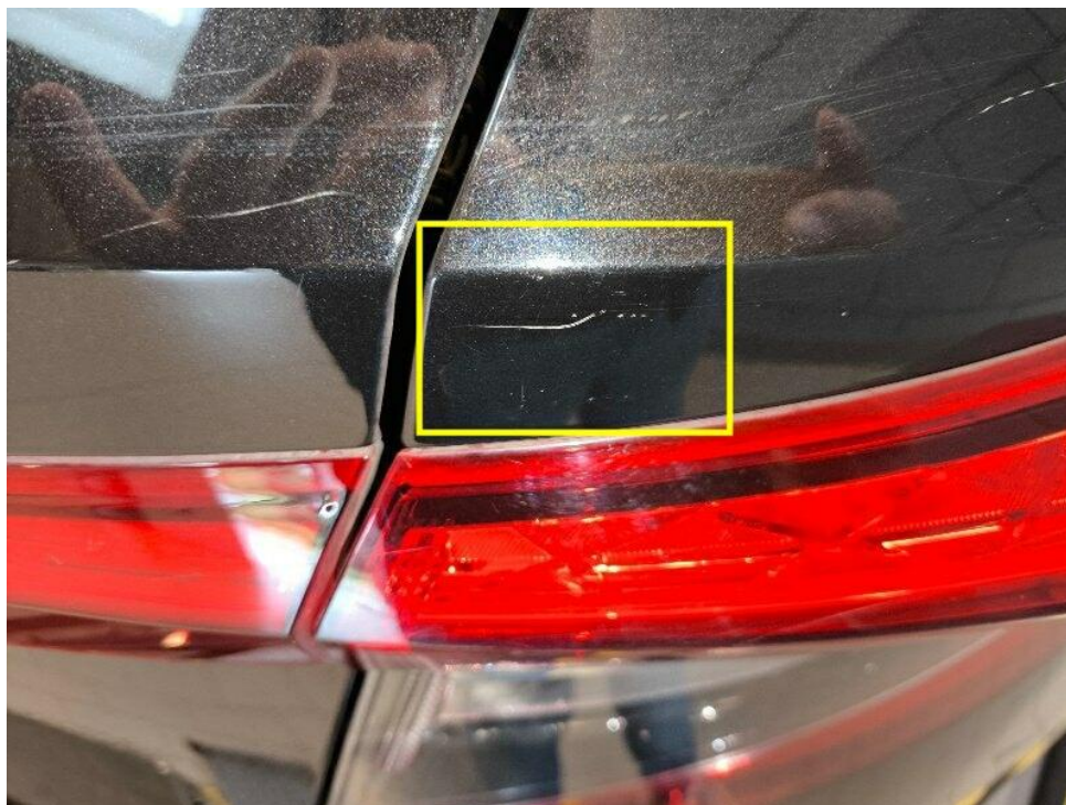
Bild 21 : Seitenteil hinten rechts Lackierung, zerkratzt, lackieren mit Lackaufbau
