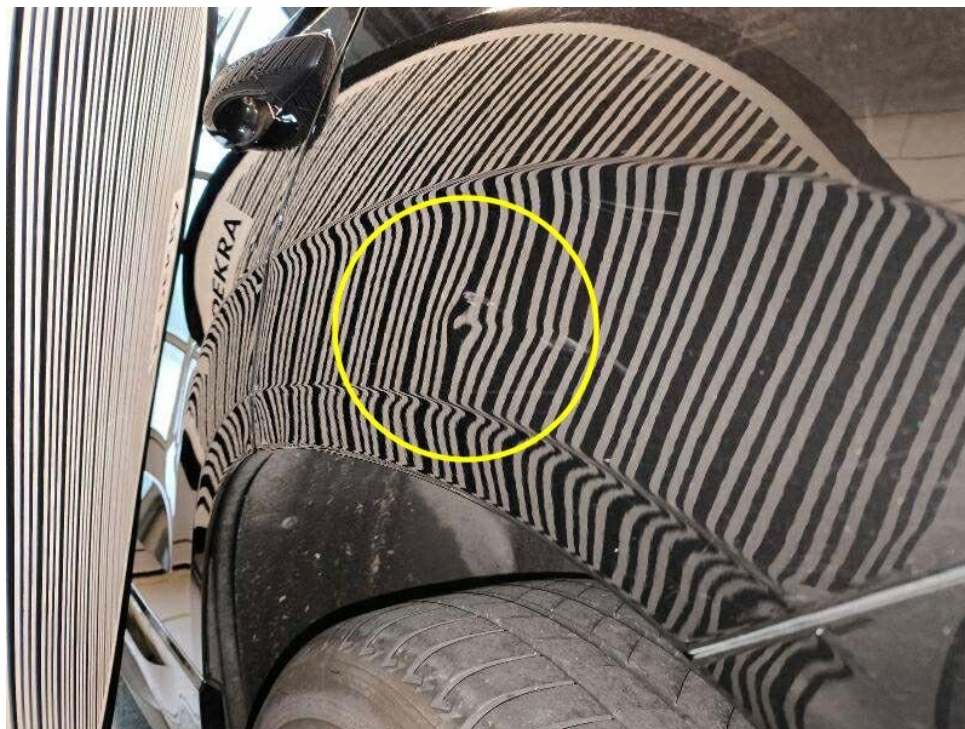
Bild 23 : Seitenteil hinten links, eingedellt, drücken
