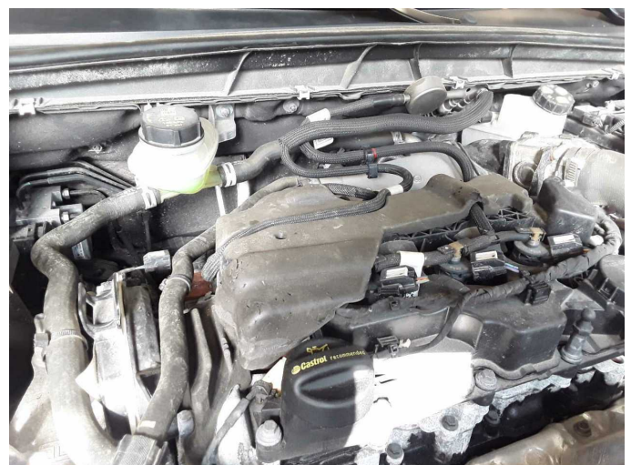
Damage 3: Engine: Engine cover (Abdeckung Fehlt, Isolierung beschädigt) - Damaged - Replace
