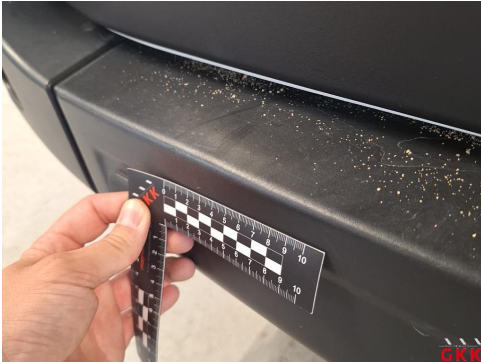
Bild 23. Stoßfänger hinten, Verkleidung -unlackiert-, beschädigt, ersetzen
