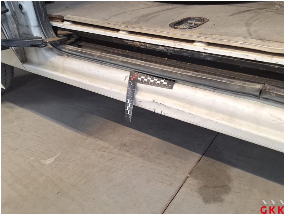
Bild 20. Schweller rechts, beschädigt, instand setzen - lackieren
