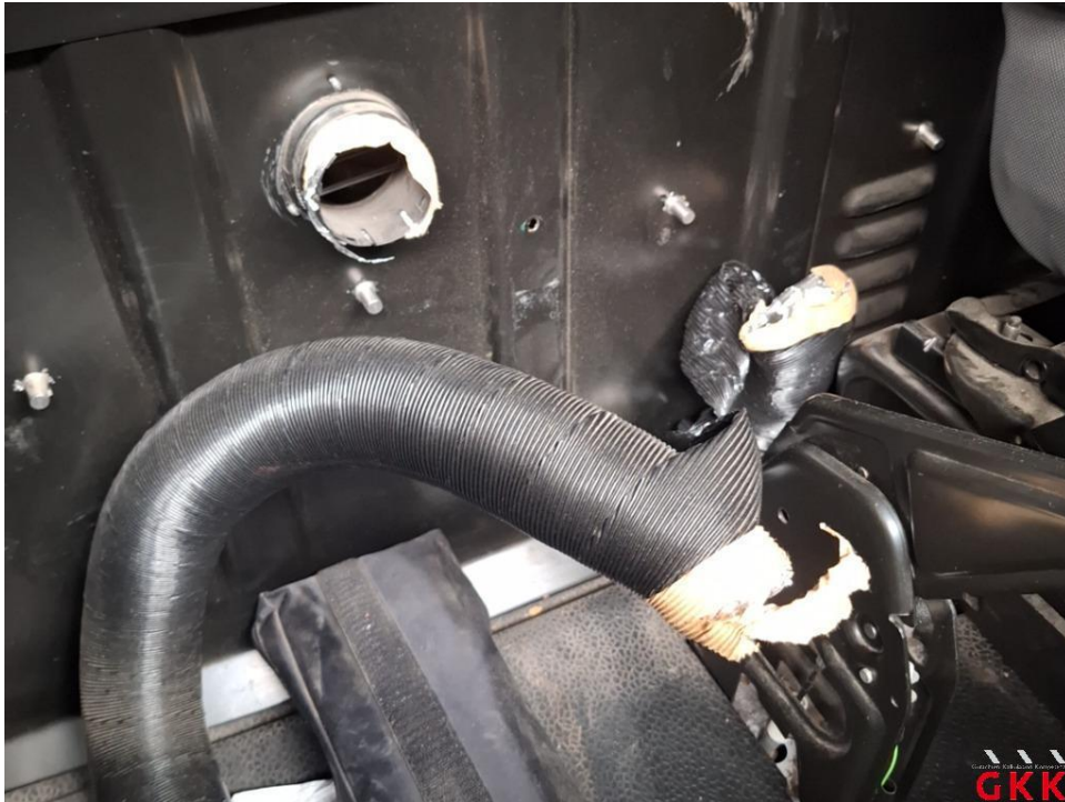
Bild 31. Laderaum Gebläse, lose, instand setzen
