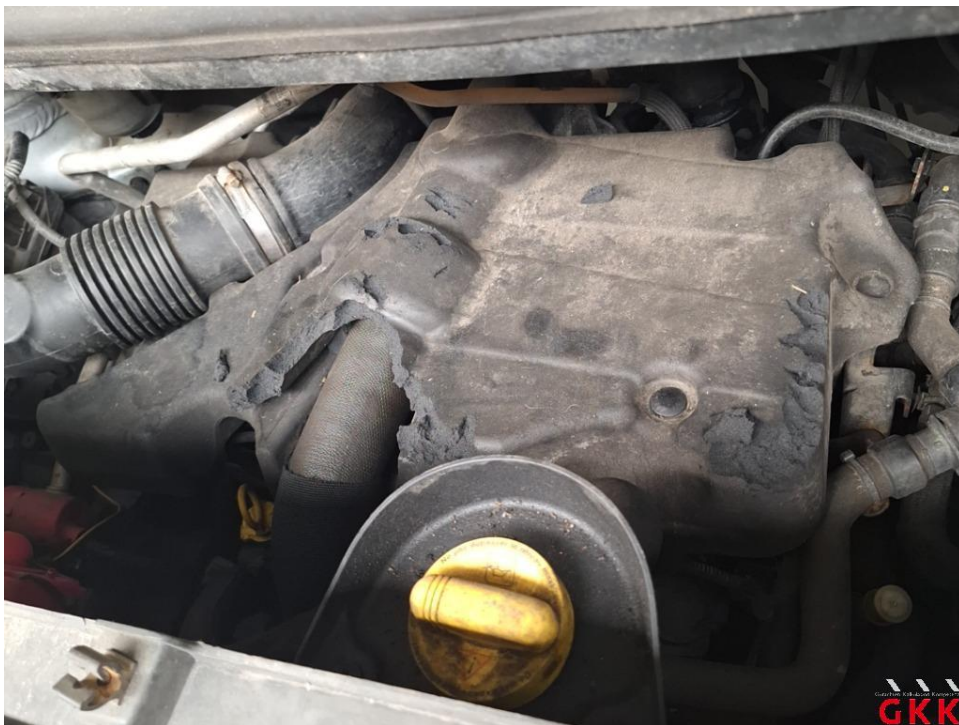
Bild 32. Motor - Abdeckung - Marderschaden, Reparaturmangel, ersetzen
