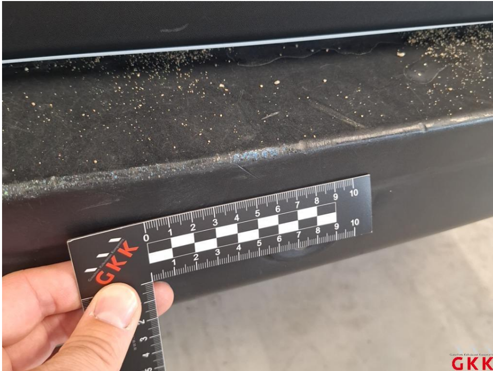
Bild 25. Stoßfänger hinten, Verkleidung -unlackiert-, beschädigt, ersetzen
