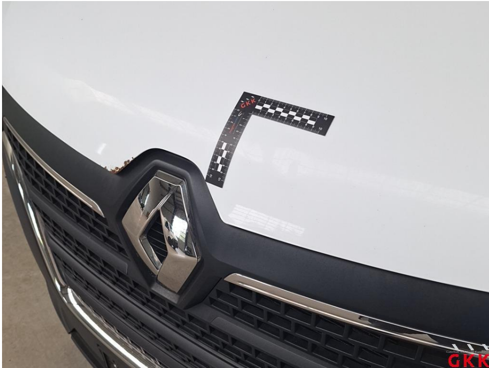
Bild 17. Motorhaube, beschädigt, instand setzen - lackieren
