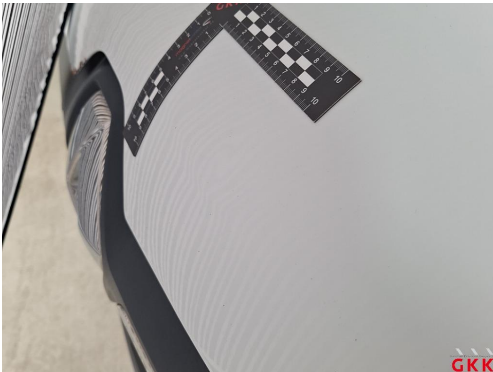
Bild 18. Motorhaube, beschädigt, instand setzen - lackieren
