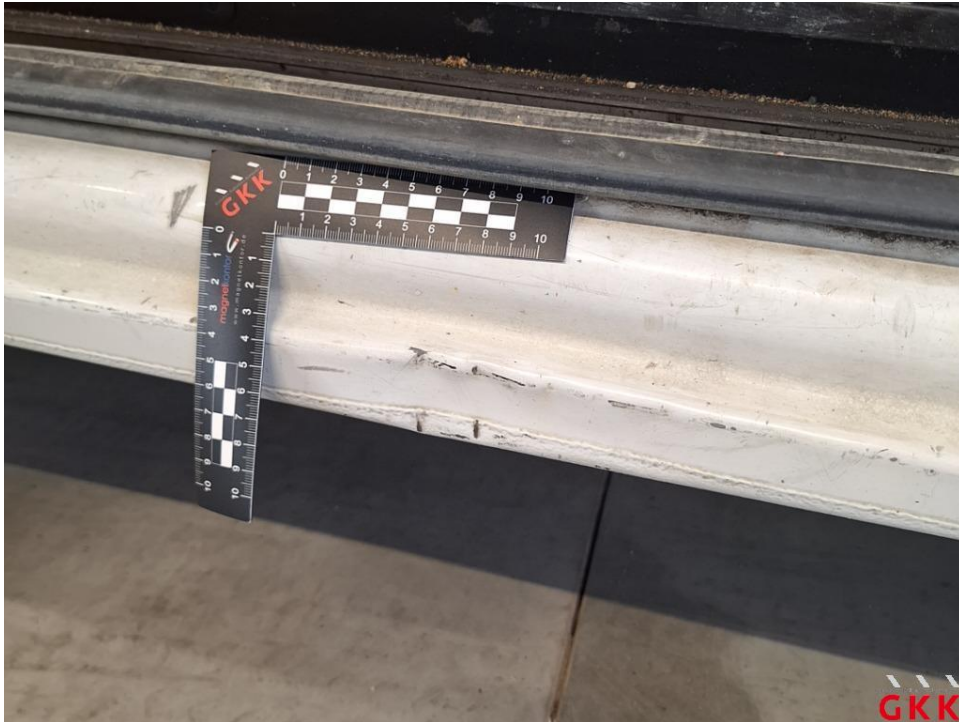
Bild 21. Schweller rechts, beschädigt, instand setzen - lackieren
