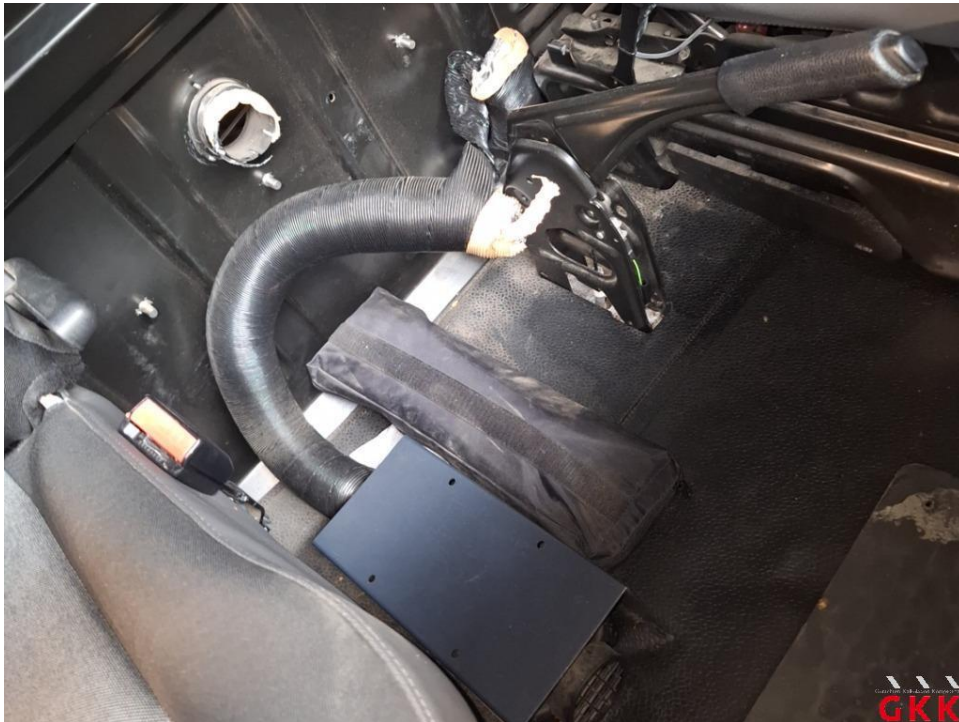
Bild 30. Laderaum Gebläse, lose, instand setzen
