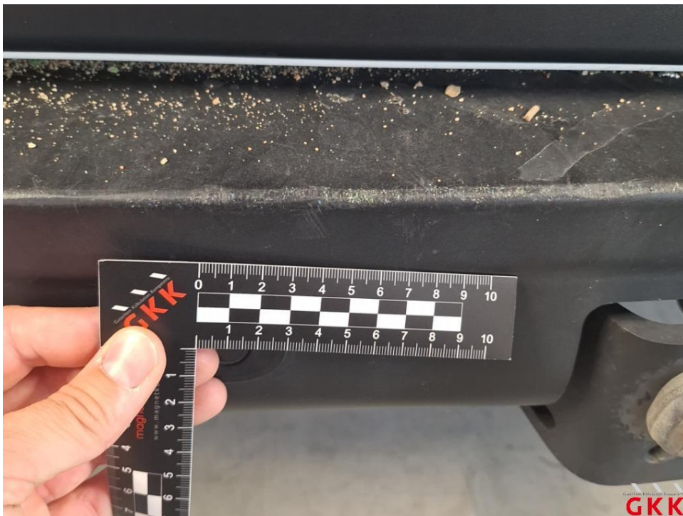
Bild 24. Stoßfänger hinten, Verkleidung -unlackiert-, beschädigt, ersetzen
