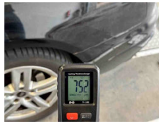
Lackstärke Seitenwand hinten links
