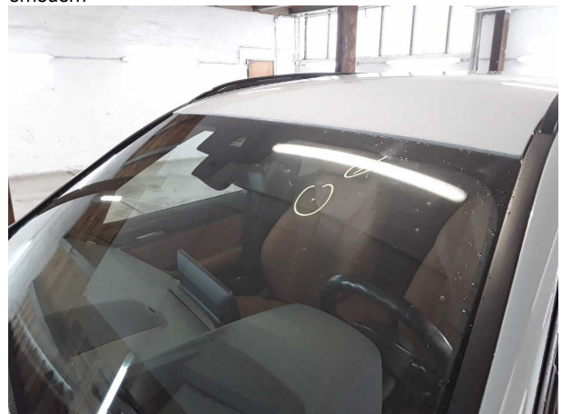
Beschädigung #4: Verglasung: Frontscheibe (Rissbildung) - Steinschlag - erneuern
