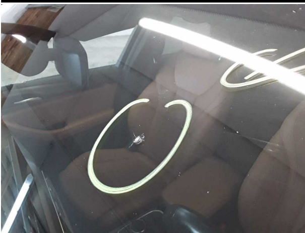
Beschädigung #4: Verglasung: Frontscheibe (Rissbildung) - Steinschlag - erneuern
