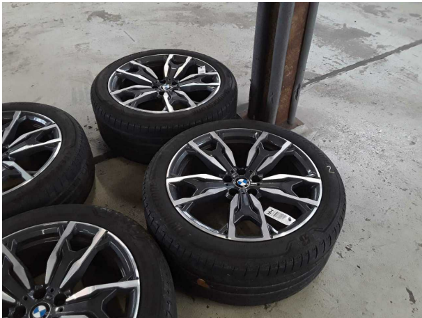
Beschädigung #2: 2.Radsatz: 2 Reifen - verschlissen - erneuern
