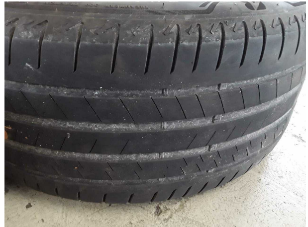
Beschädigung #2: 2.Radsatz: 2 Reifen - verschlissen - erneuern
