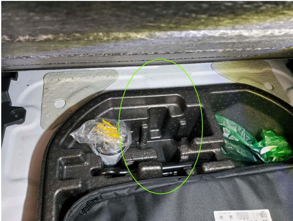
Bild 7 : Kompressor Reifenpannenset fehlt
