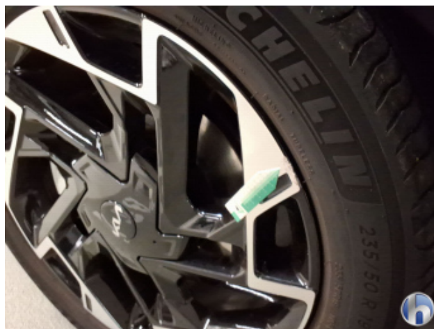
1. Felge Vorne - Links Kratzer - Smart Repair
