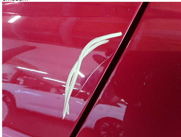
Beschädigung #6: Tür hinten links: Tür - verkratzt / verschürft... lackieren
