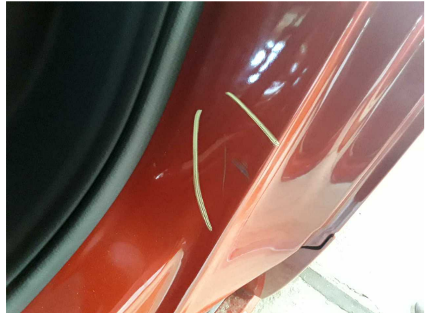
Beschädigung #1: Seitenwand links: Einstieg - verkratzt / verschürft - Smart Repair
