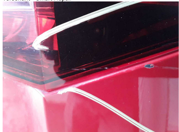
Beschädigung #2: Heckleuchte: Heckleuchte rechts (Außen) - verkratzt / verschürft - erneuern
