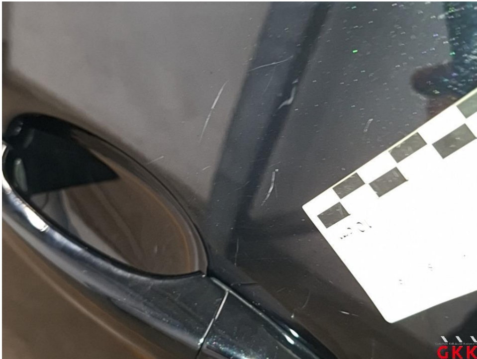
Bild 23 Tür vorne links, verkratzt, lackieren
