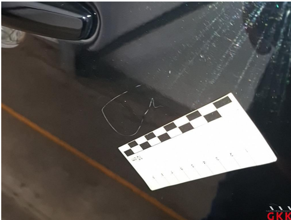
Bild 40 Schiebetür links, verkratzt, lackieren
