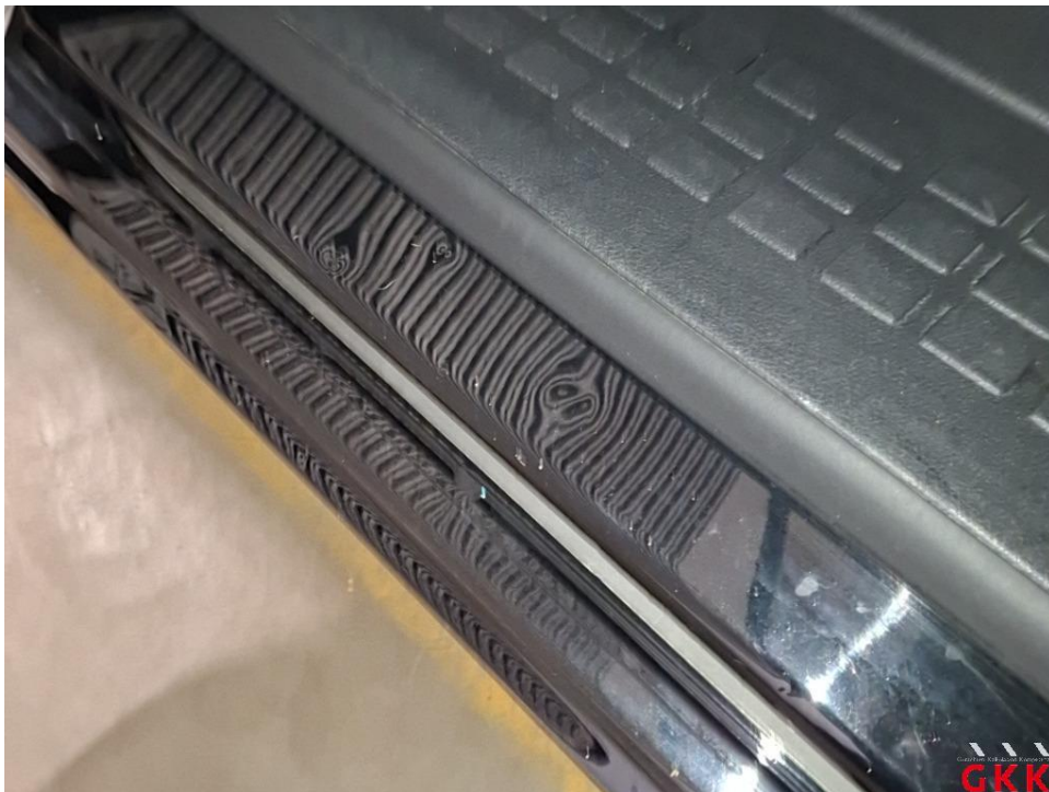
Bild 24 Tür hinten links, Einstieg, beschädigt, instand setzen - lackieren
