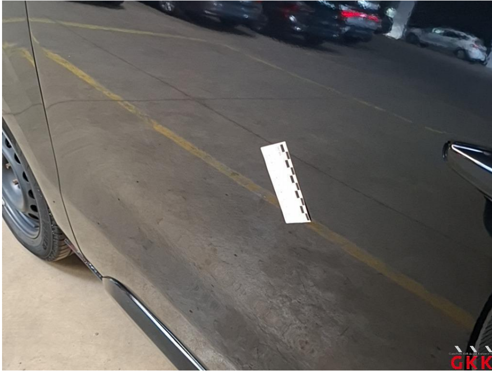
Bild 33 Schiebetür rechts, beschädigt, instand setzen - lackieren
