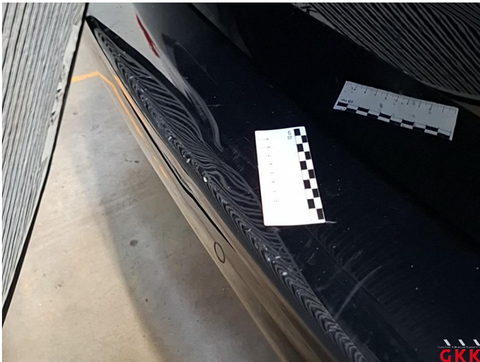
Bild 30 Stoßfänger hinten, Verkleidung -lackiert-, beschädigt, ersetzen
