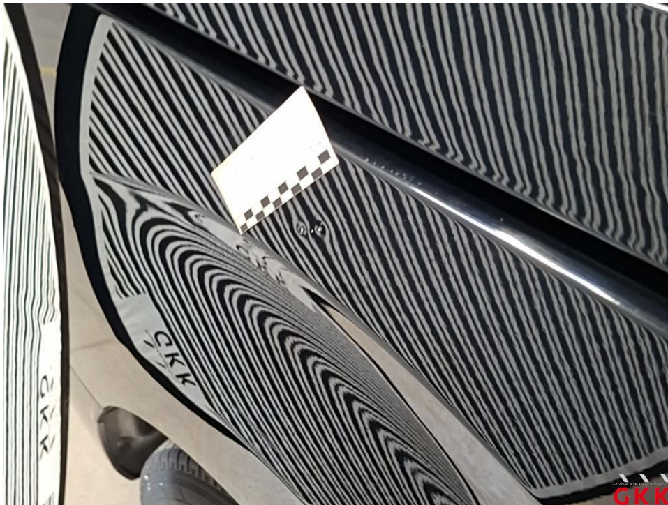
Bild 32 Seitenwand rechts, unterhalb, beschädigt, instand setzen - lackieren
