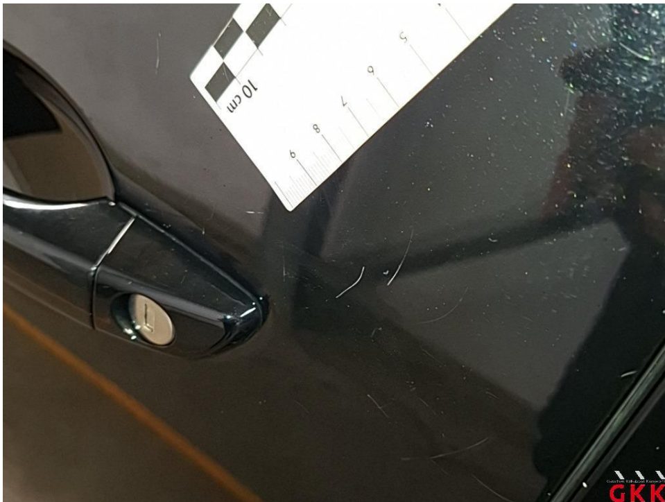
Bild 22 Tür vorne links, verkratzt, lackieren
