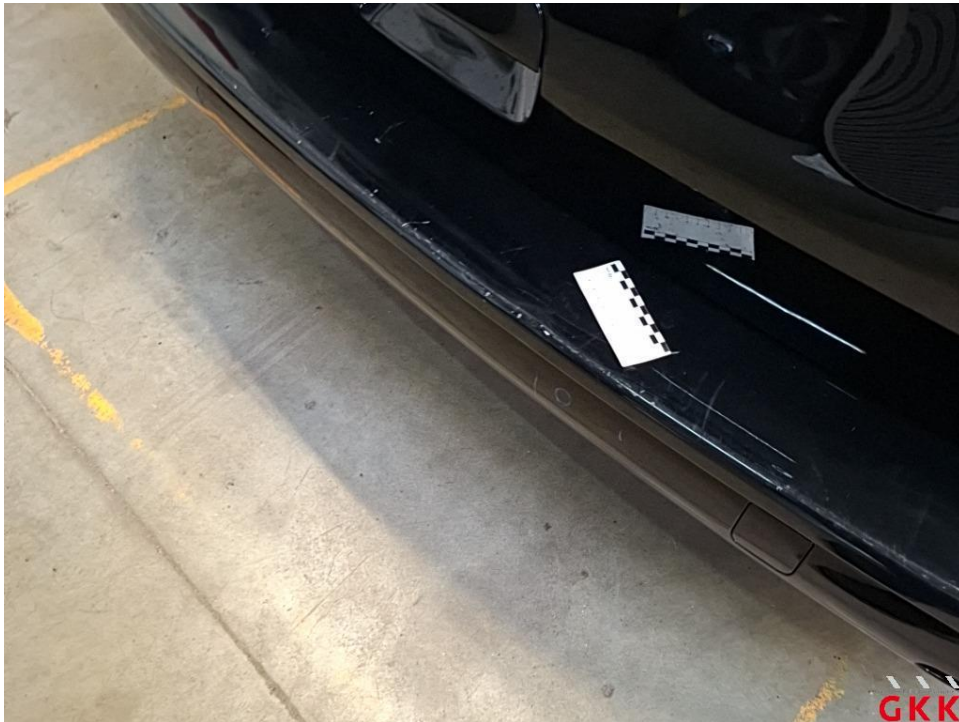
Bild 29 Stoßfänger hinten, Verkleidung -lackiert-, beschädigt, ersetzen
