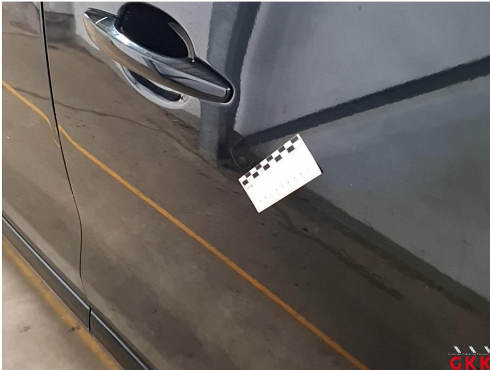
Bild 39 Schiebetür links, verkratzt, lackieren
