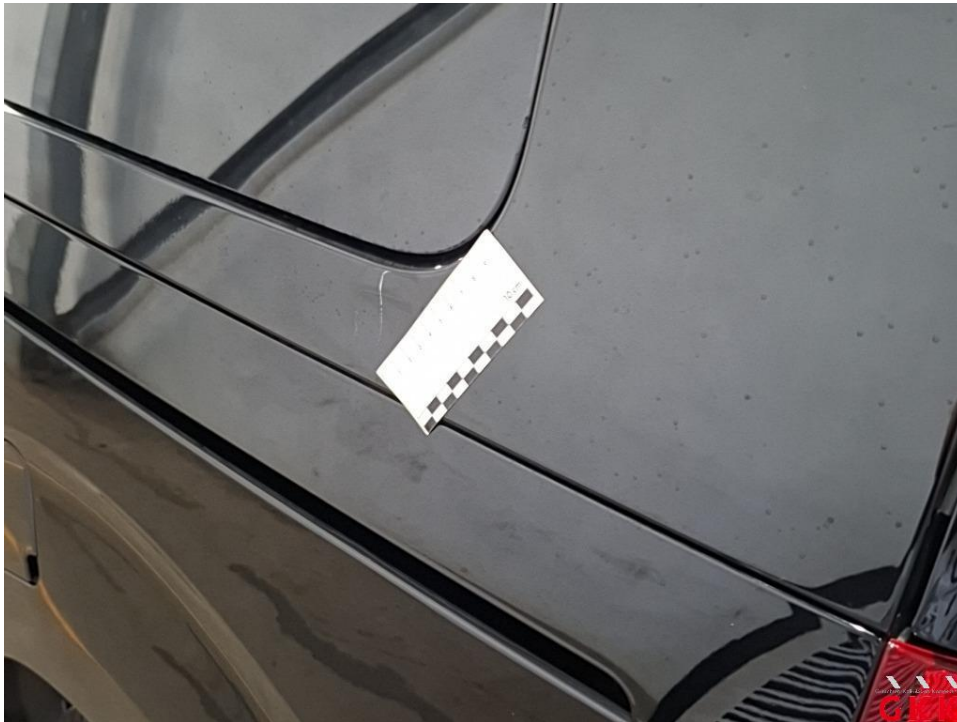
Bild 27 Seitenwand links, verkratzt, lackieren
