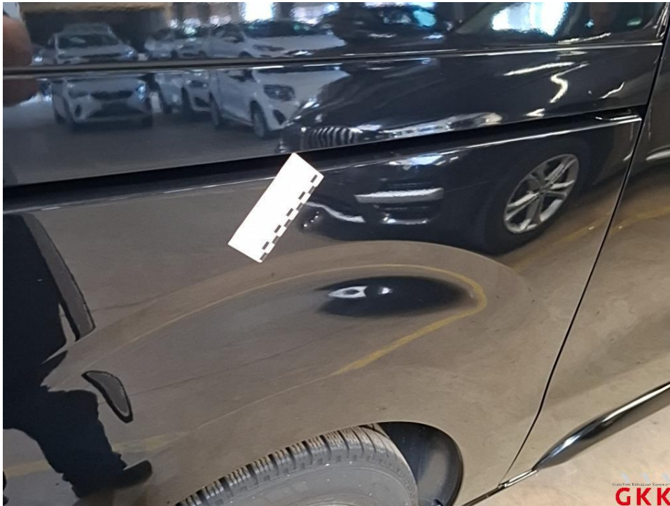
Bild 31 Seitenwand rechts, unterhalb, beschädigt, instand setzen - lackieren
