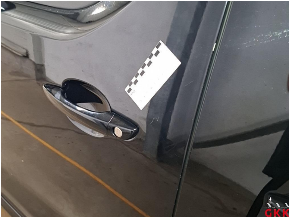
Bild 21 Tür vorne links, verkratzt, lackieren
