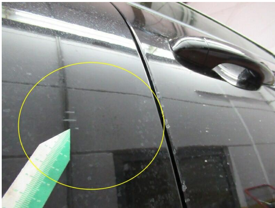
Bild 14 : Tür hinten rechts leicht zerkratzt ( Oberflächlich )
