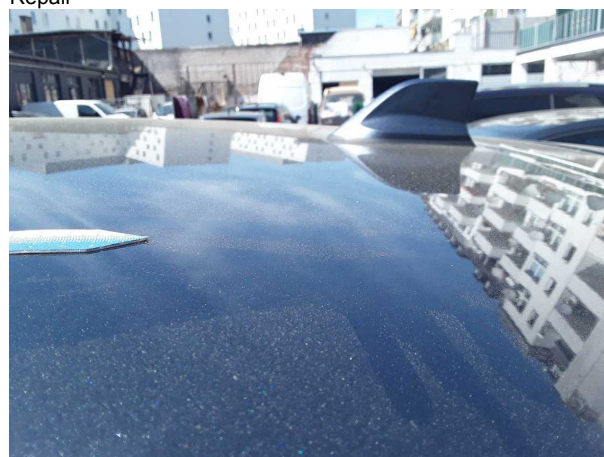
Beschädigung #2: Fahrzeugdach: Dach - Delle(n) - sanft instandsetzen
