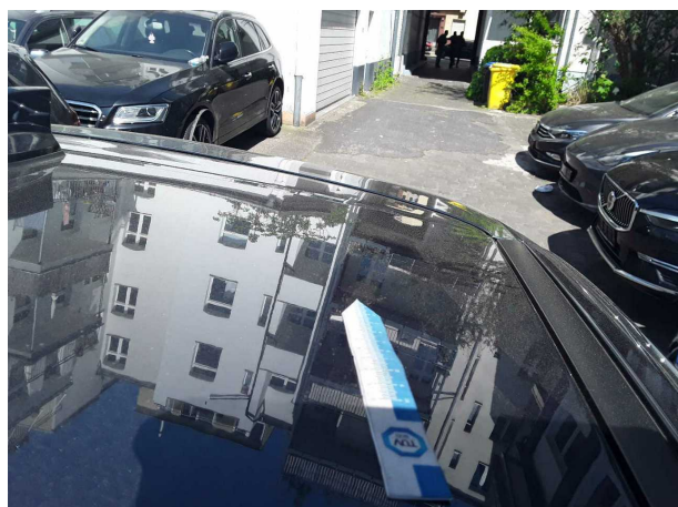
Beschädigung #2: Fahrzeugdach: Dach - Delle(n) - sanft instandsetzen
