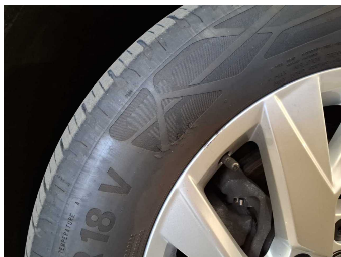
Damage 3: Wheel / tyres: Tyre - front left side (Flankenbeschädigung) - Damaged - Replace
