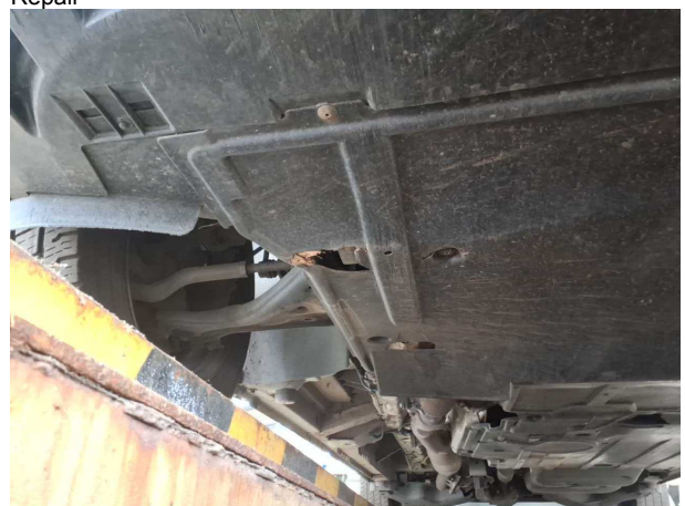
Beschädigung #9: Motor: Motorverkleidung unten - gebrochen / gerissen - erneuern
