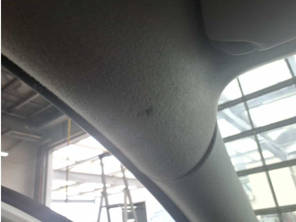
Beschädigung #4: Verkleidungen/Abdeckungen: Dachhimmel - Brandloch - Smart Repair
