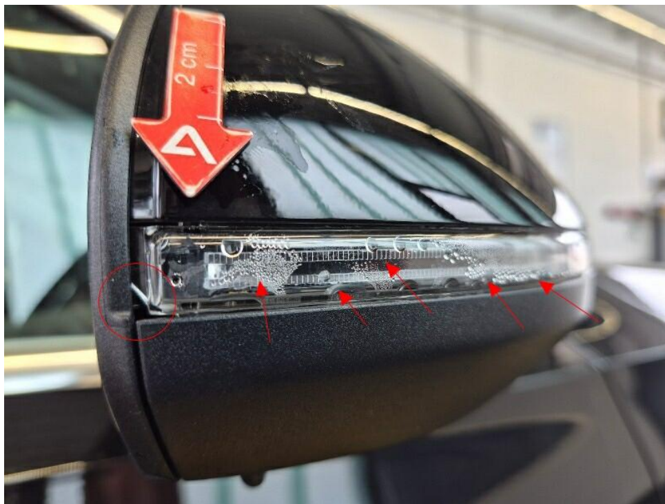
Bild 16 : Tür vorn rechts Aussenspiegel Zusatzblinkleuchte gebrochen mit Feuchtigkeitseintritt
