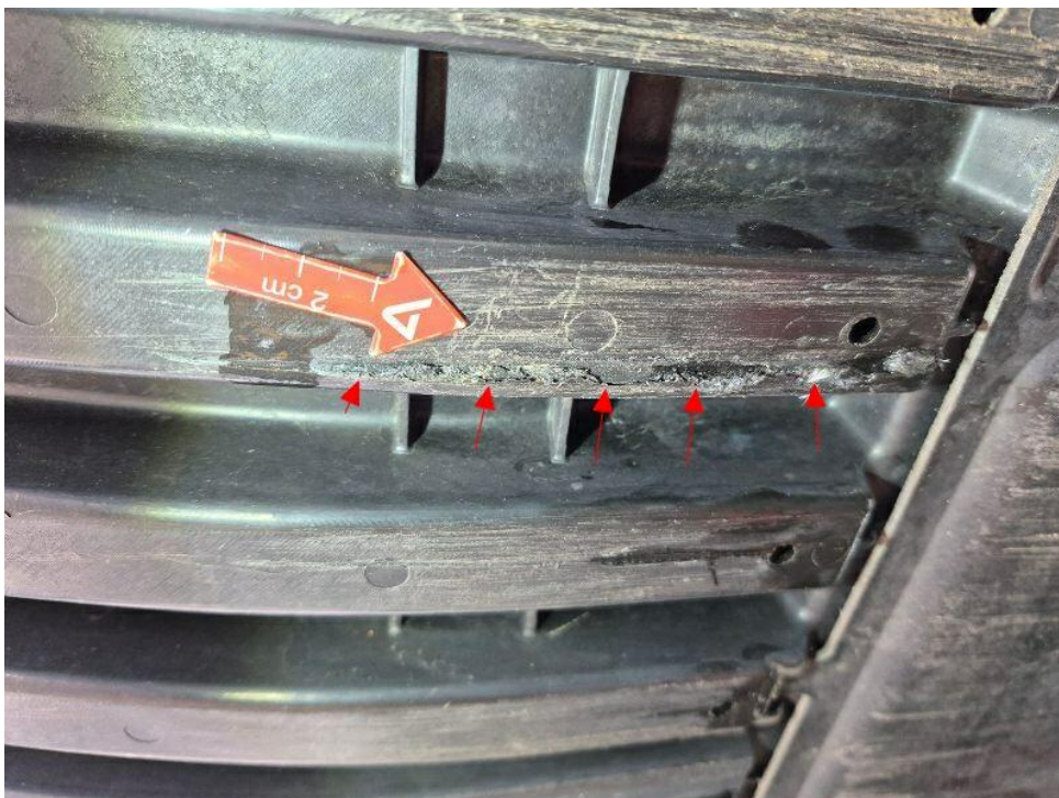
Bild 26 : Stoßfängerverkleidung vorn Schließteil unten gebrochen (Aufsetzschaden)
