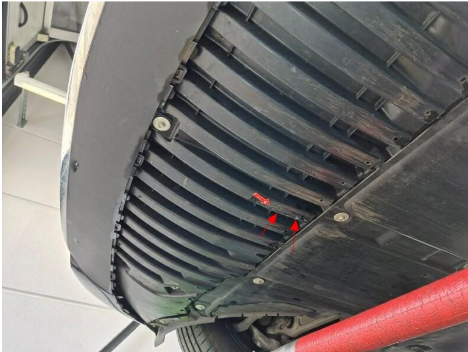
Bild 25 : Stoßfängerverkleidung vorn Schließteil unten gebrochen (Aufsetzschaden)
