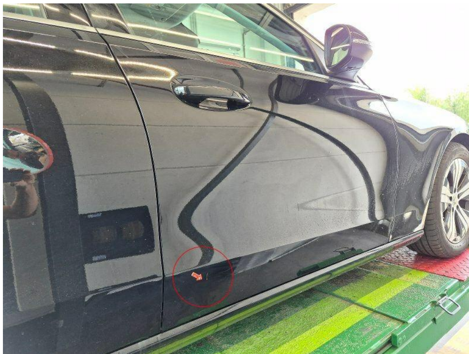
Bild 23 : Tür vorne rechts Lackierung unterhalb, zerkratzt, lackieren mit Lackaufbau
