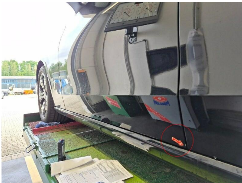
Bild 21 : Tür vorn links Türkante hinten unten partiell verschrammt
