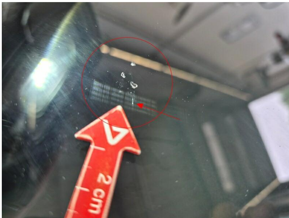
Bild 15 : Frontscheibe Steinschläge mit Rissbildung
