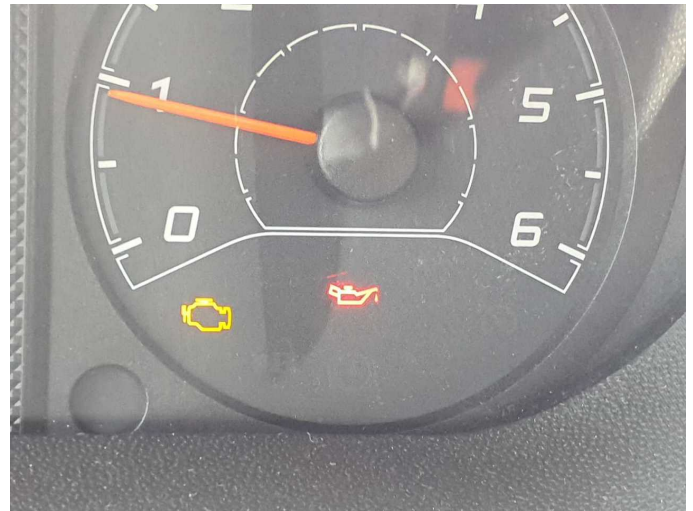
Damage 5: Instrument panel: Indicator light (Öldruck, hohe Mehrkosten wahrscheinlich) - on - Perform diagnosis
