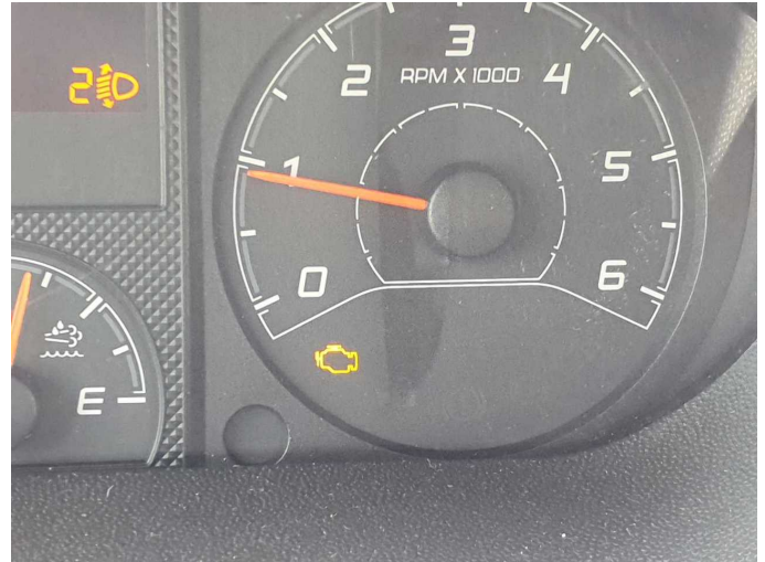
Damage 7: Instrument panel: Indicator light (Motorkontrolleuchte, Mehrkosten möglich) - on - Perform diagnosis
