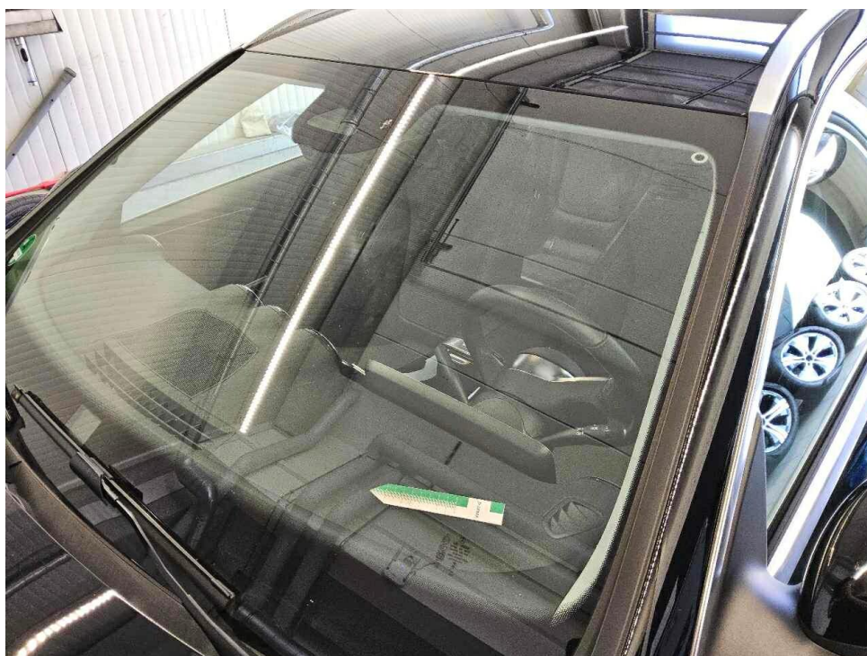
Bild 16 : Frontscheibe, mehrere leichte Abplatzungen
