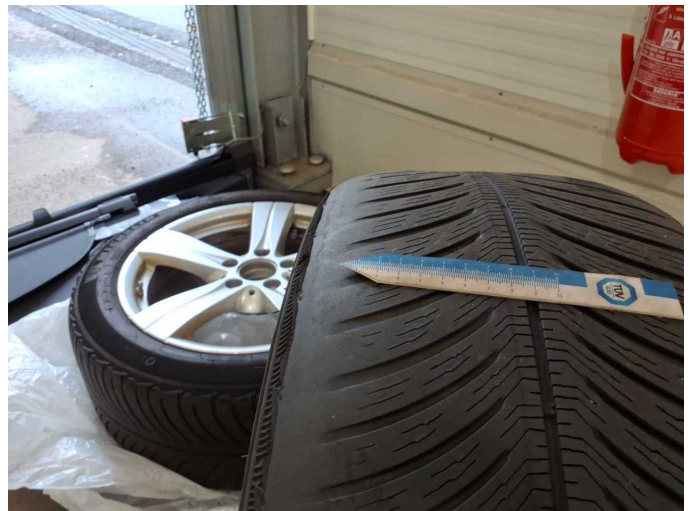
Damage 4: 2nd wheel set: 1 tyre (Kante abgefahren) - Worn - Replace
