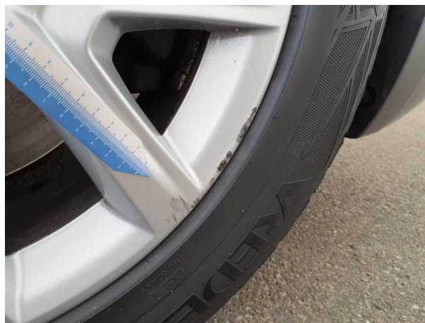
Beschädigung #4: Rad/Reifen: Leichtmetallfelge vorn rechts (Sicherheitsrelevant) - Funktion / Zulässigkeit - Wertminderung
