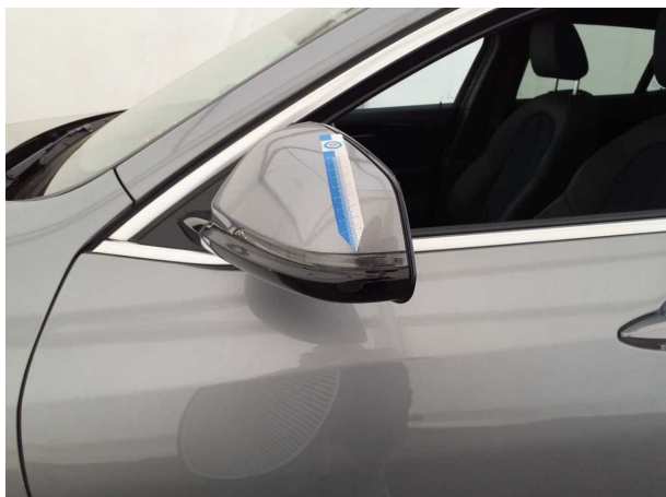
Beschädigung #2: Außenspiegel links: Abdeckkappe - Kratzer - Smart Repair
