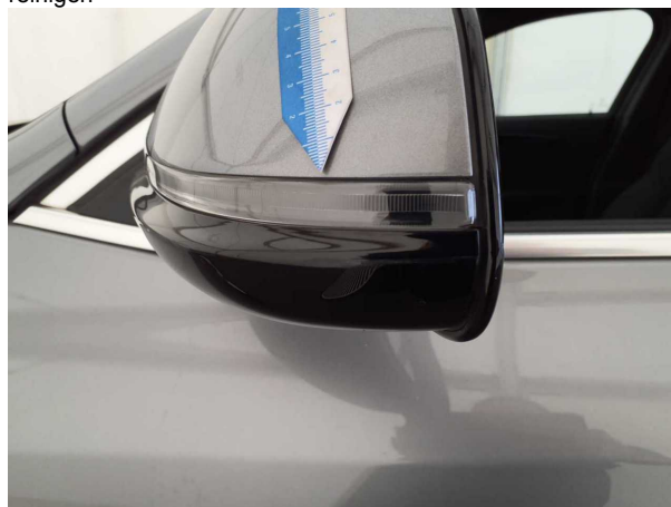
Beschädigung #2: Außenspiegel links: Abdeckkappe - Kratzer - Smart Repair
