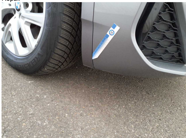
Beschädigung #3: Kotflügel rechts: Radhausverbreiterung - Kratzer - Smart Repair
