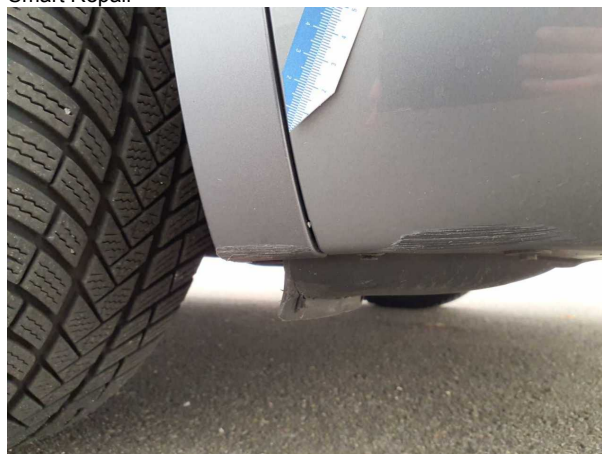
Beschädigung #3: Kotflügel rechts: Radhausverbreiterung - Kratzer - Smart Repair
