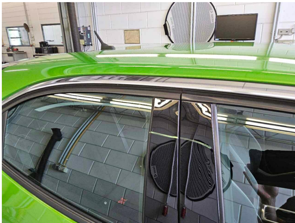
Bild 16 : Zierleisten Fensterrahmen B-Säule links und rechts eingedellt
