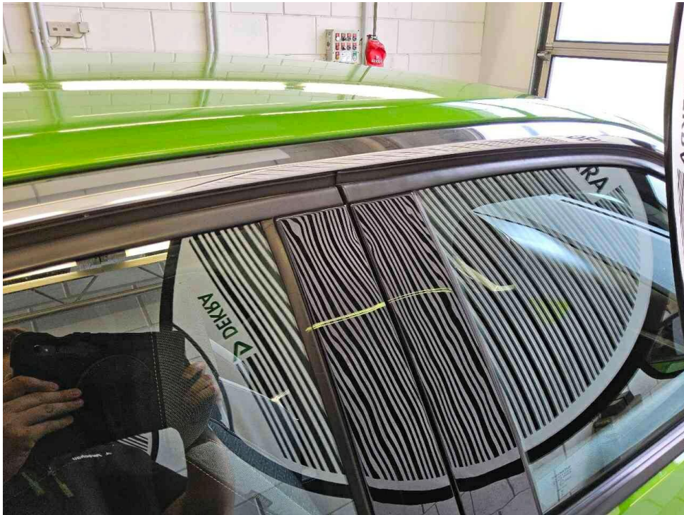
Bild 17 : Zierleisten Fensterrahmen B-Säule links und rechts eingedellt
