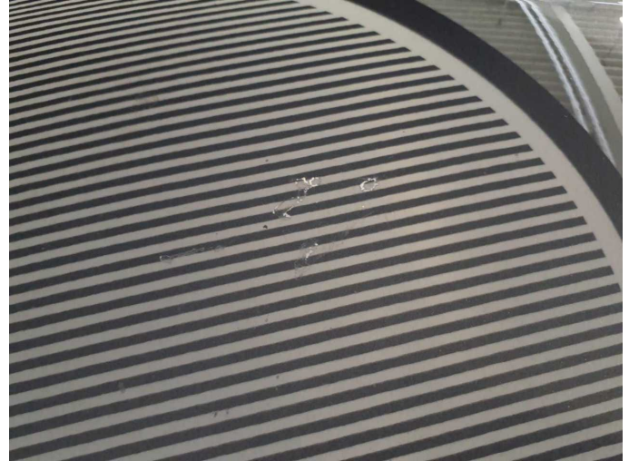
Damage 8: Bonnet: Bonnet (Anätzung) - Paint defect - Paint
