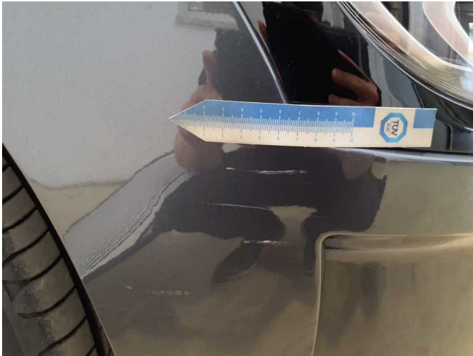
Damage 6: Front bumper: Front bumper (Zusätzlich Blende rechts Kratzer) - Scratch(es) - Paint
