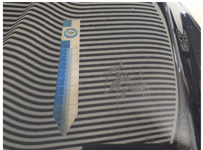
Damage 8: Bonnet: Bonnet (Anätzung) - Paint defect - Paint
