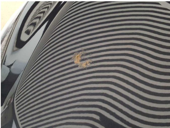
Damage 8: Bonnet: Bonnet (Anätzung) - Paint defect - Paint
