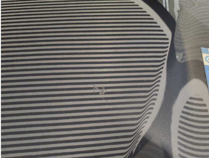
Damage 8: Bonnet: Bonnet (Anätzung) - Paint defect - Paint
