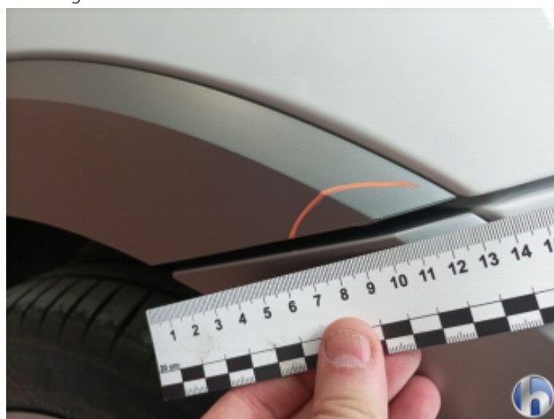
1. Seitenwand - Hinten - Links Kratzer - Smart Repair
