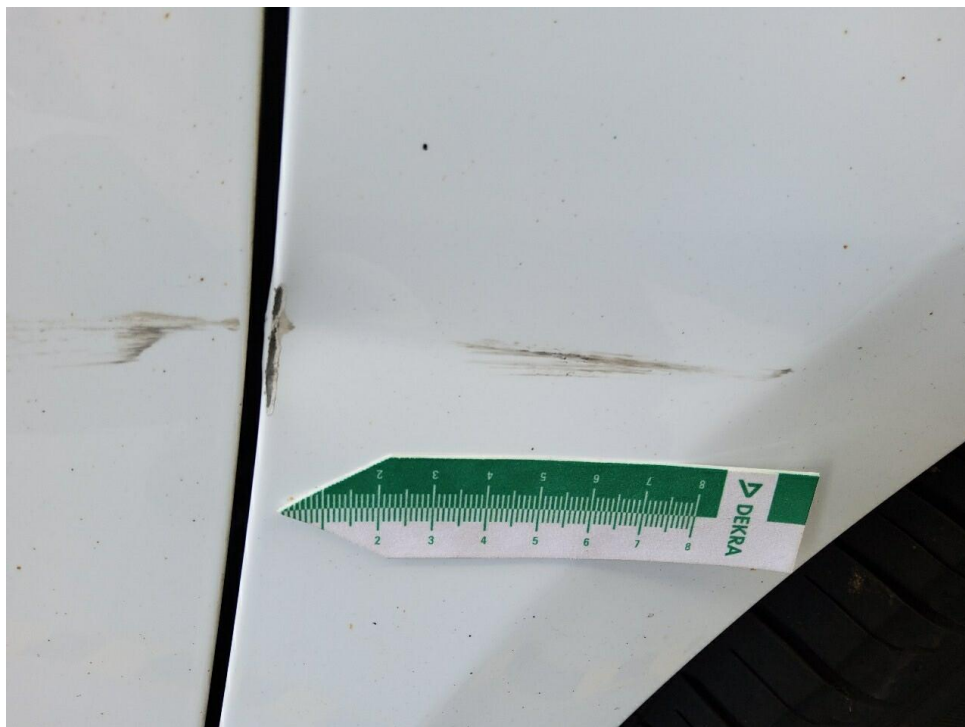
Bild 10 : Unfallschaden rechts Kotflügel
