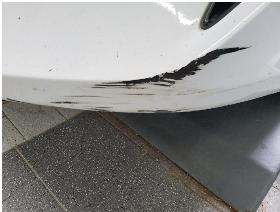
Bild 6 : Stoßfänger vorne Lackierung, verschrämmt, smart repair
