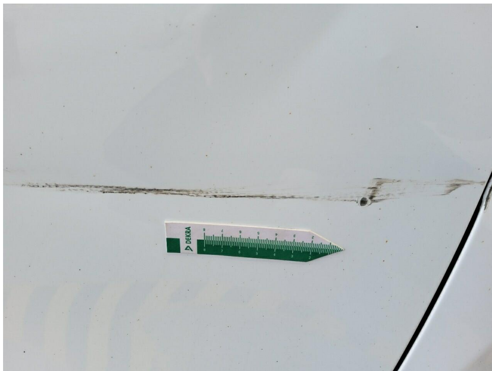
Bild 9 : Unfallschaden rechts Türe vorne rechts
