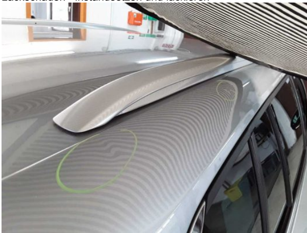
Beschädigung #10: Karosserie: Karosserie (Mehrkosten möglich...) Hagelschaden - instandsetzen
