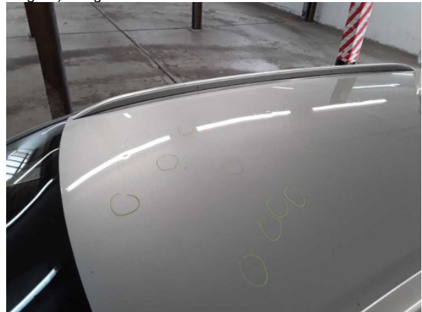
Beschädigung #10: Karosserie: Karosserie (Mehrkosten möglich... Hagelschaden - instandsetzen
