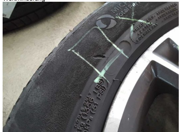
Beschädigung #3: 2.Radsatz: 1 Reifen - beschädigt - erneuern
