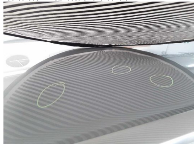
Beschädigung #10: Karosserie: Karosserie (Mehrkosten möglich...) Hagelschaden - instandsetzen
