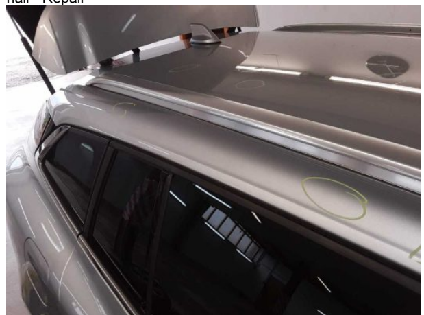
Damage #10: Body: Body (Mehrkosten möglich) - Damage by hail - Repair
