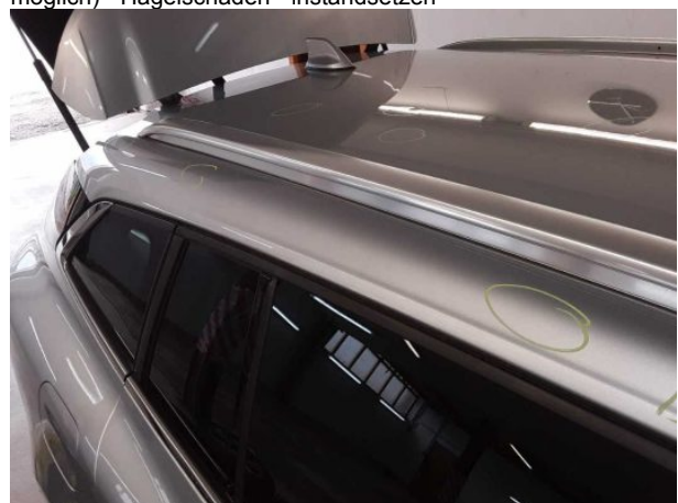
Beschädigung #10: Karosserie: Karosserie (Mehrkosten möglich... Hagelschaden - instandsetzen
