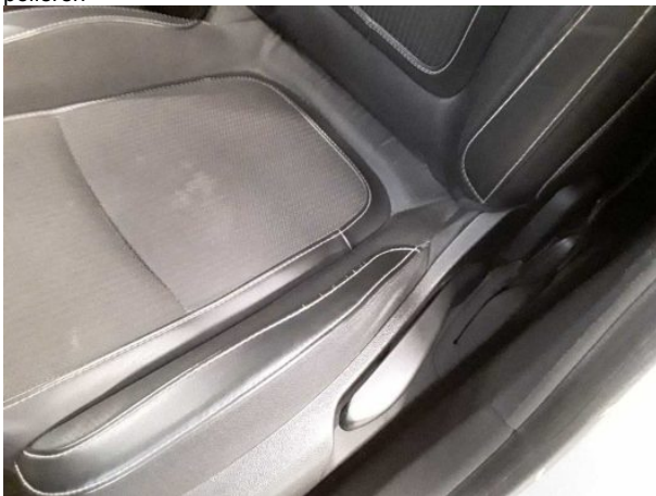
Beschädigung #2: Sitz vorn: Sitzbezug links - porös / rissig - Wertminderung
