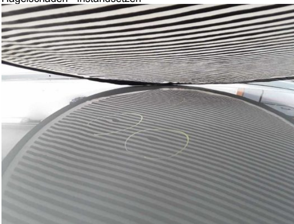
Beschädigung #10: Karosserie: Karosserie (Mehrkosten möglich...) Hagelschaden - instandsetzen
