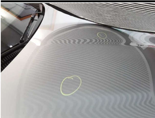
Beschädigung #10: Karosserie: Karosserie (Mehrkosten möglich... Hagelschaden - instandsetzen
