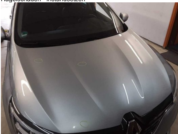
Beschädigung #10: Karosserie: Karosserie (Mehrkosten möglich... Hagelschaden - instandsetzen
