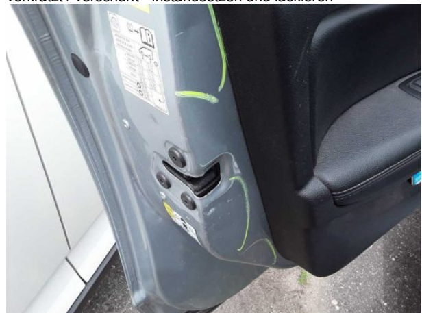
Beschädigung #9: Tür vorn links: Tür (innen) - Delle / Lackschaden - instandsetzen und lackieren
