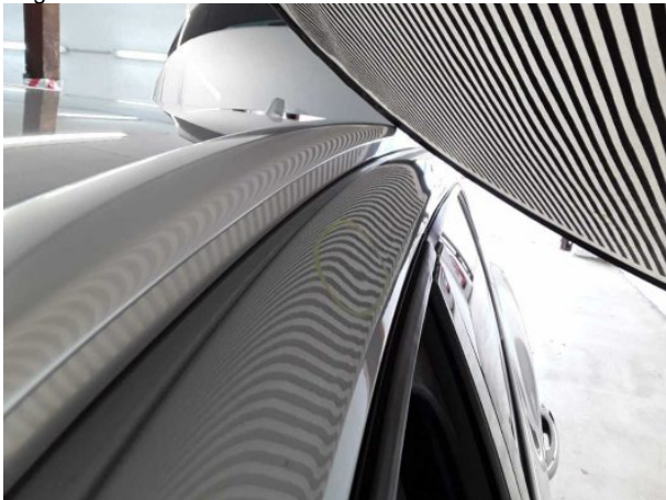
Beschädigung #10: Karosserie: Karosserie (Mehrkosten möglich... Hagelschaden - instandsetzen
