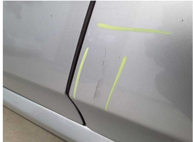
Beschädigung #1: Tür hinten links: Tür - Abrieb - auslegen / polieren
