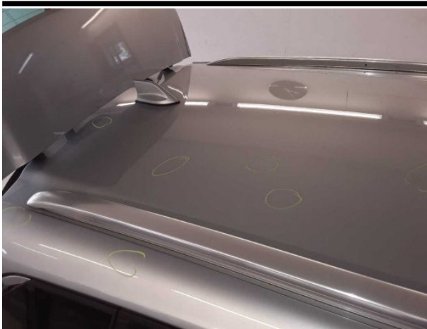
Beschädigung #10: Karosserie: Karosserie (Mehrkosten möglich... Hagelschaden - instandsetzen
