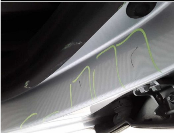
Beschädigung #6: Schweller links: Einstieg - Delle / Lackschade... instandsetzen und lackieren
