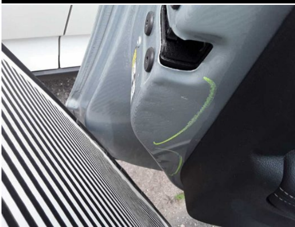
Beschädigung #9: Tür vorn links: Tür (innen) - Delle / Lackschaden - instandsetzen und lackieren
