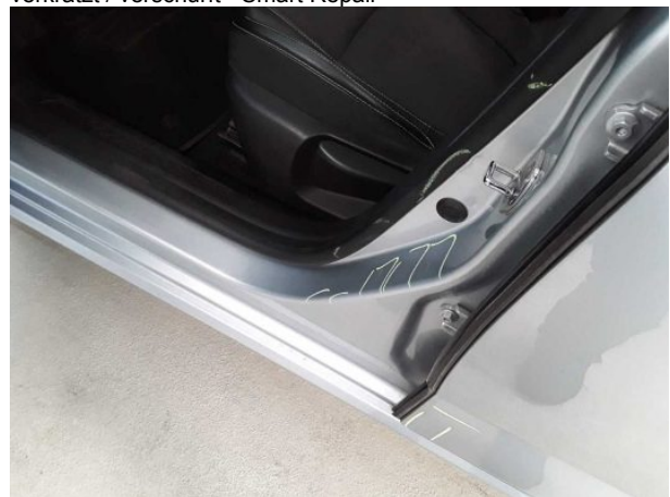
Beschädigung #6: Schweller links: Einstieg - Delle / Lackschaden - instandsetzen und lackieren
