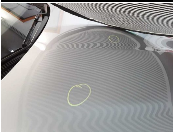
Damage #10: Body: Body (Mehrkosten möglich) - Damage by hail - Repair
