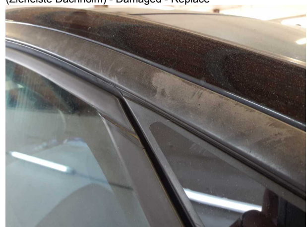
Damage #6: Door - front right side: Brightware - upper (Zierleiste Dachholm) - Damaged - Replace
