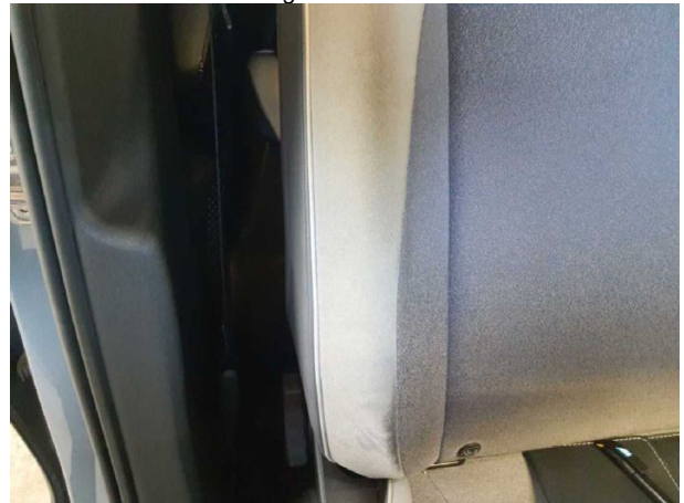
Beschädigung #9: Sitz vorn: Lehnenbezug rechts - Abrieb - erneuern
