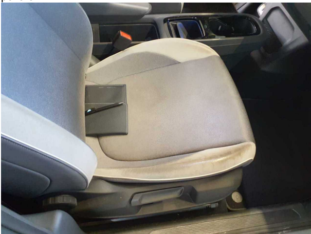
Beschädigung #2: Sitz vorn: Sitzbezug rechts - Abrieb - reinigen
