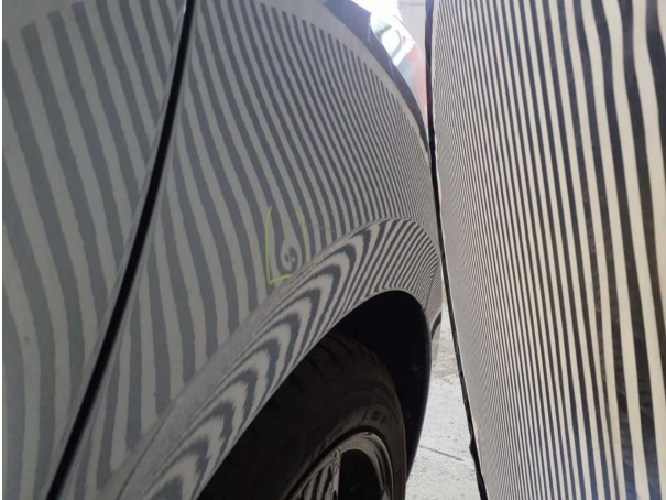
Beschädigung #4: Seitenwand links: Seitenwand - Delle(n) - sanft instandsetzen
