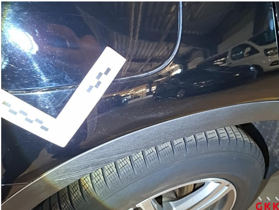
Bild 48 Seitenwand rechts, verkratzt, lackieren
