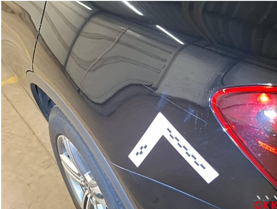
Bild 39 Seitenwand links, beschädigt, instand setzen - lackieren
