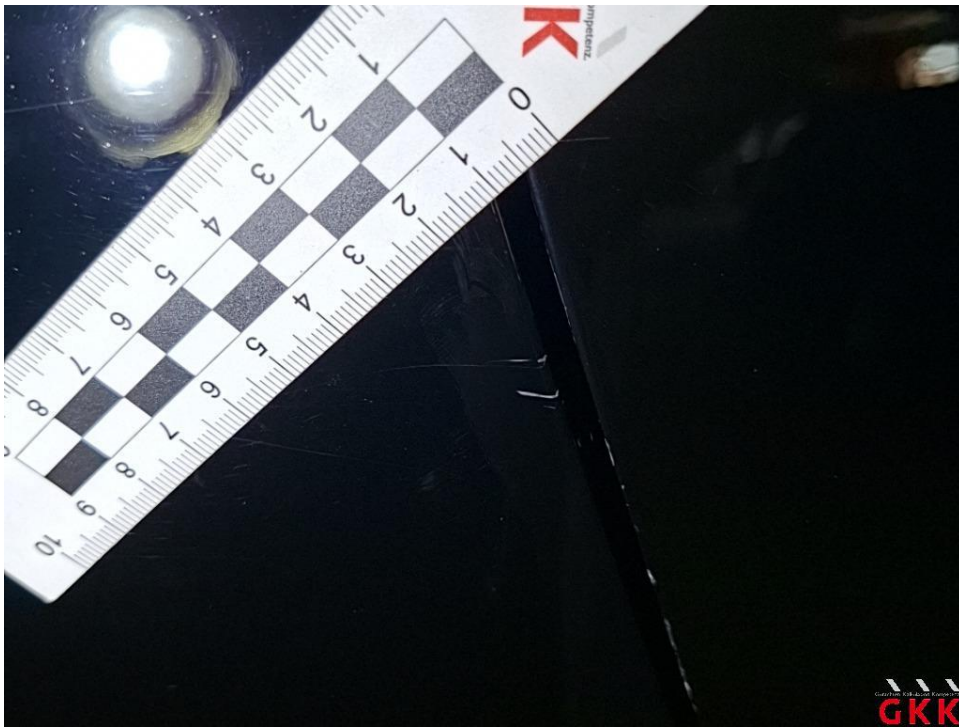
Bild 50 Seitenwand rechts, verkratzt, lackieren
