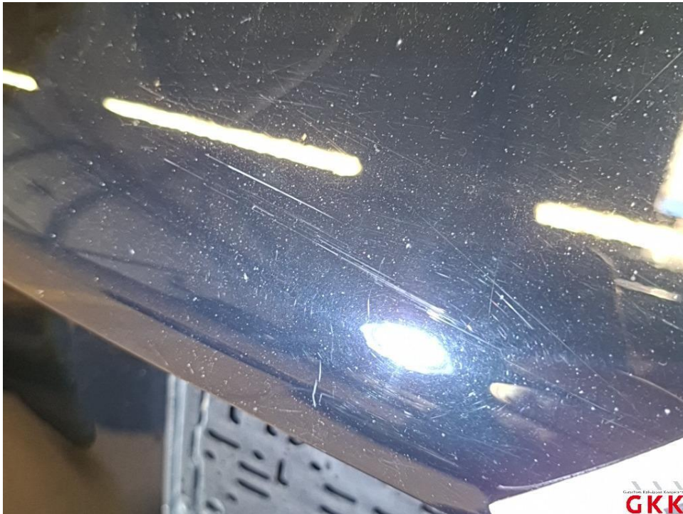
Bild 47 Heckklappe, unterhalb, verkratzt, lackieren
