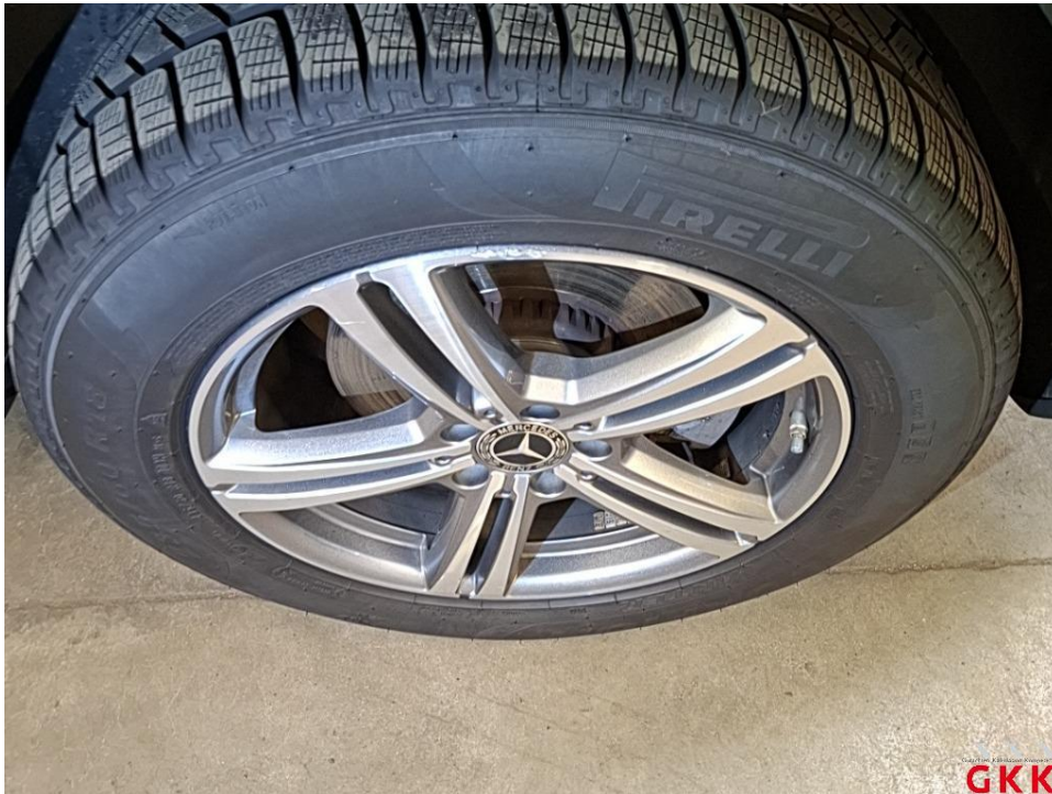
Bild 63 LM-Rad, hinten links, Materialabtrag, ersetzen
