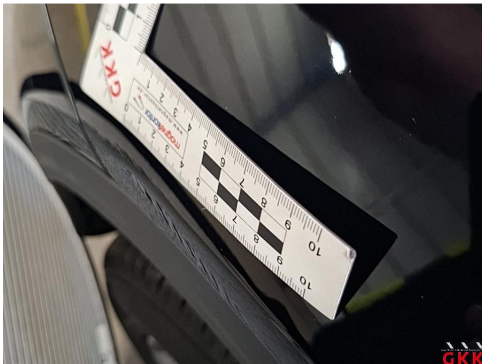
Bild 30 Kotflügel vorne links, beschädigt, instand setzen - lackieren
