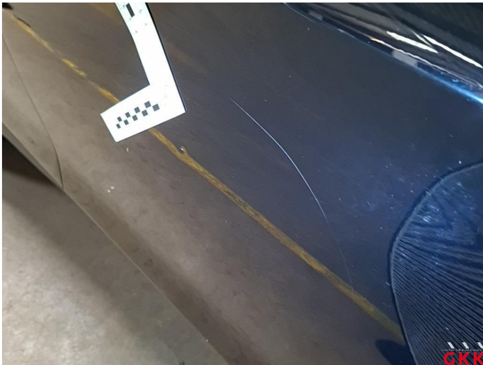
Bild 58 Tür vorne rechts, beschädigt, instand setzen - lackieren
