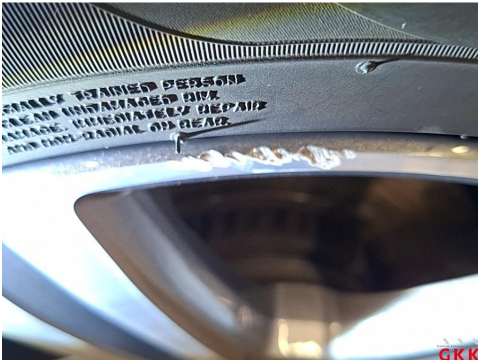
Bild 64 LM-Rad, hinten links, Materialabtrag, ersetzen
