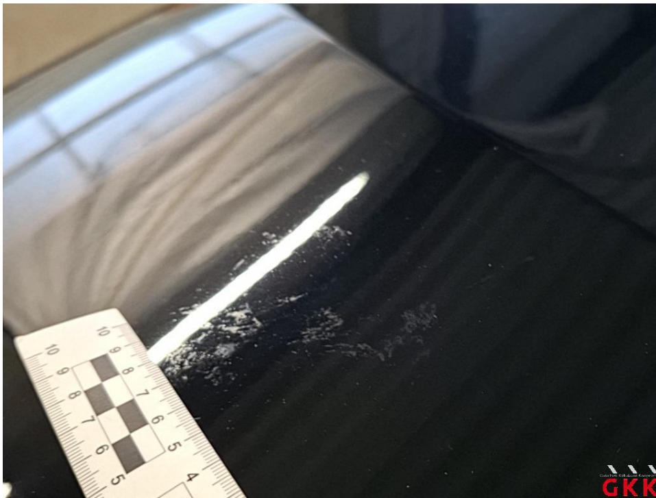
Bild 28 Fahrzeug, außen, Anhaftungsspuren, aufbereiten
