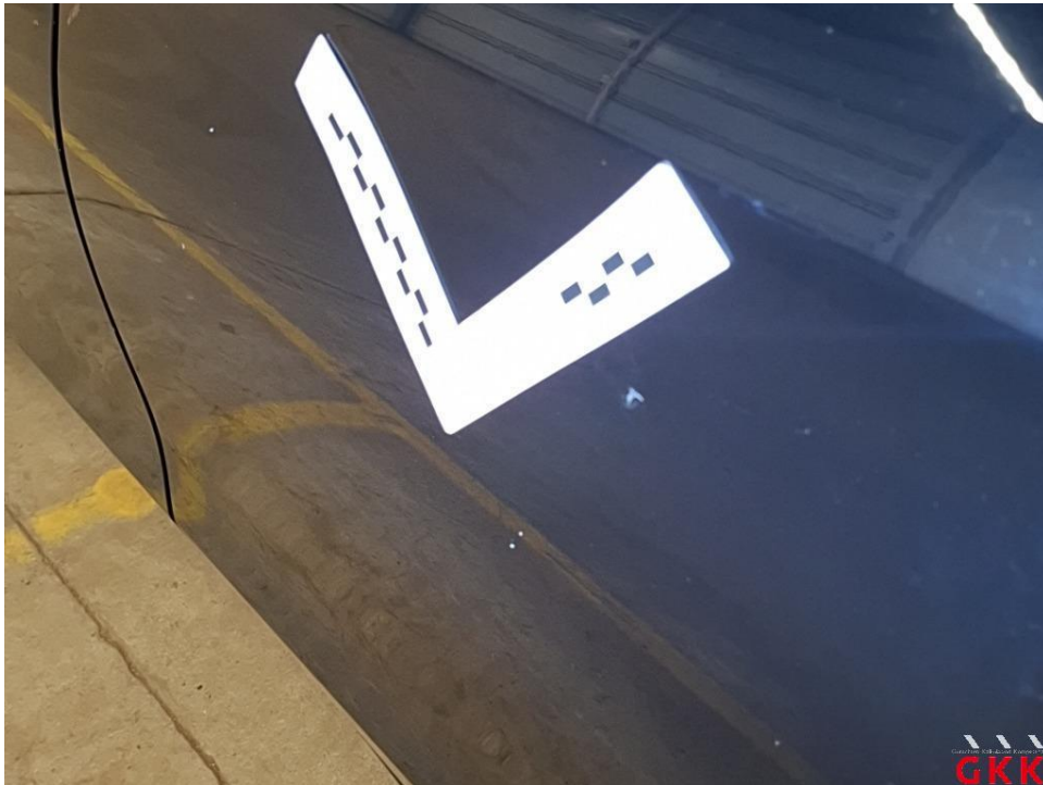
Bild 37 Tür hinten links, Steinschlag und Kratzer, lackieren
