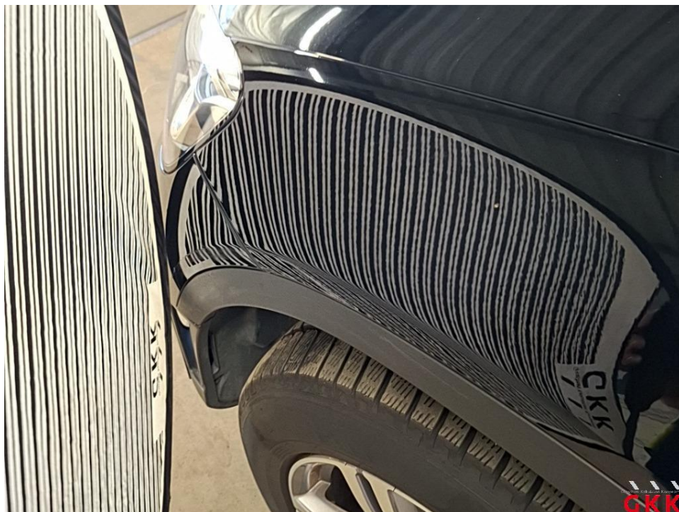
Bild 29 Kotflügel vorne links, beschädigt, instand setzen - lackieren
