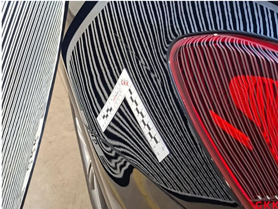
Bild 41 Seitenwand links, beschädigt, instand setzen - lackieren
