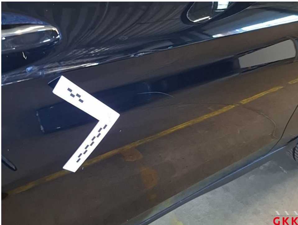
Bild 56 Tür vorne rechts, beschädigt, instand setzen - lackieren
