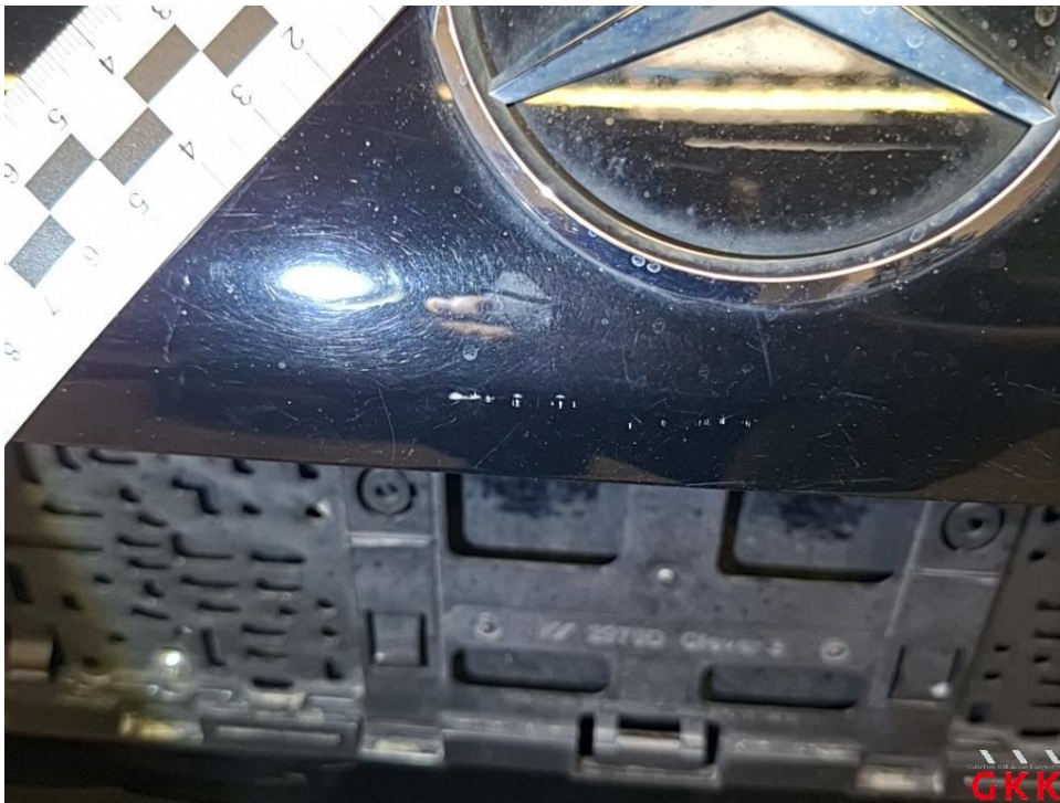
Bild 46 Heckklappe, unterhalb, verkratzt, lackieren
