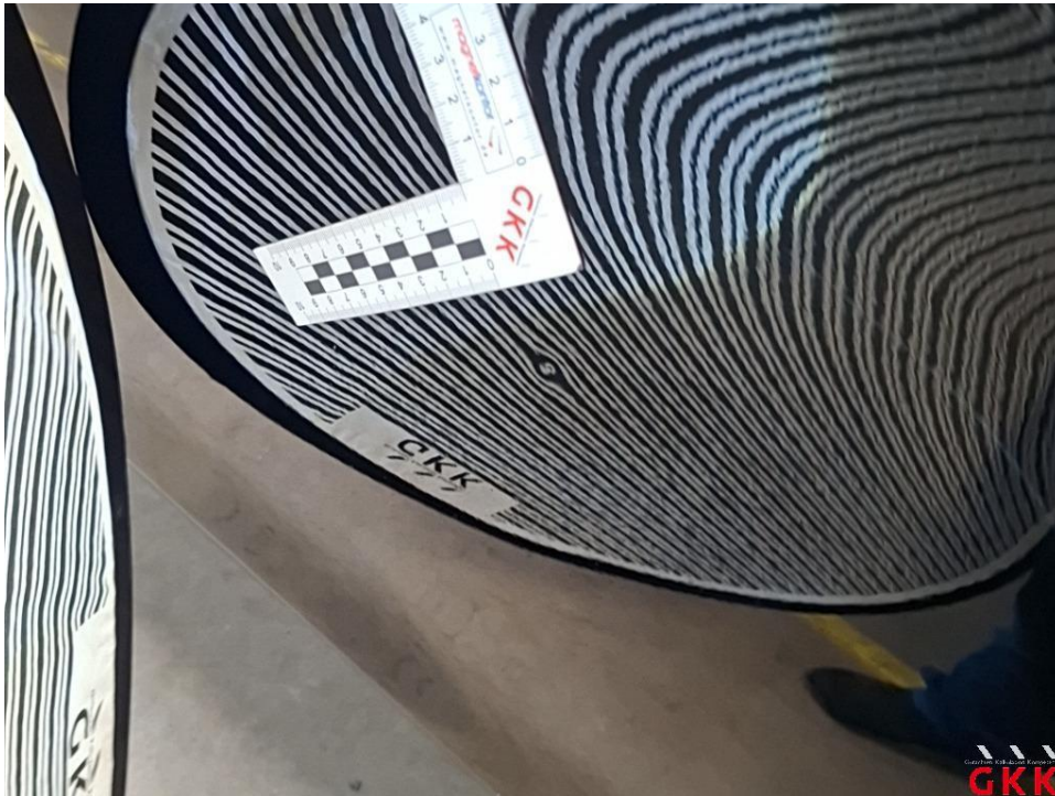
Bild 57 Tür vorne rechts, beschädigt, instand setzen - lackieren
