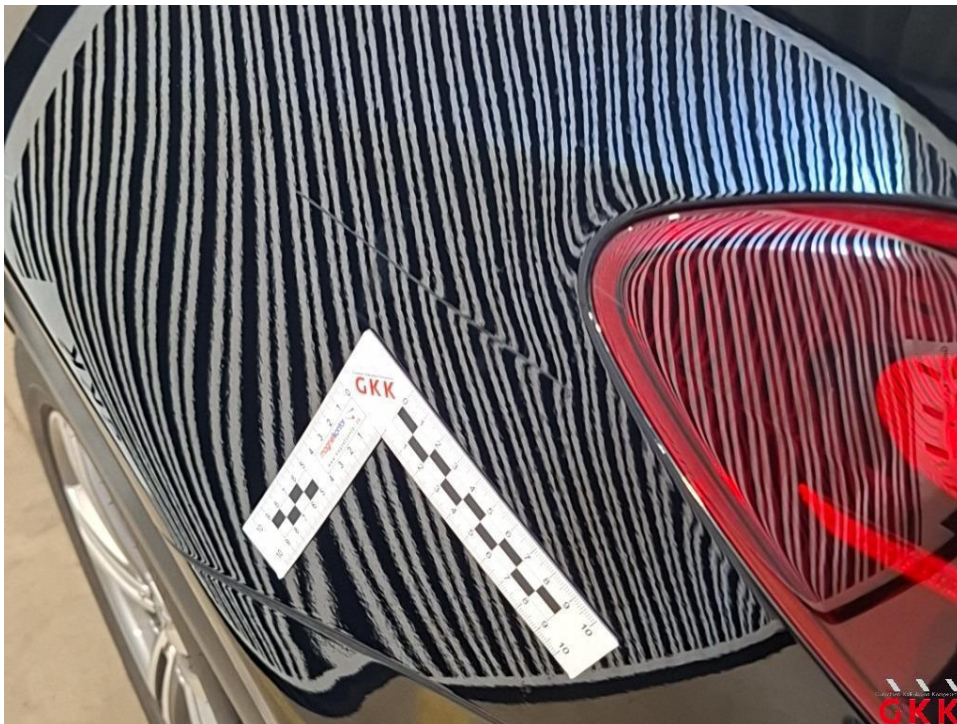
Bild 40 Seitenwand links, beschädigt, instand setzen - lackieren
