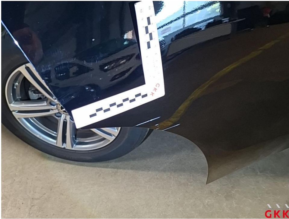
Bild 53 Tür hinten rechts, beschädigt, instand setzen - lackieren
