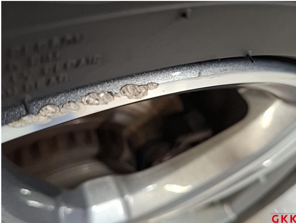
Bild 65 LM-Rad, hinten links, Materialabtrag, ersetzen
